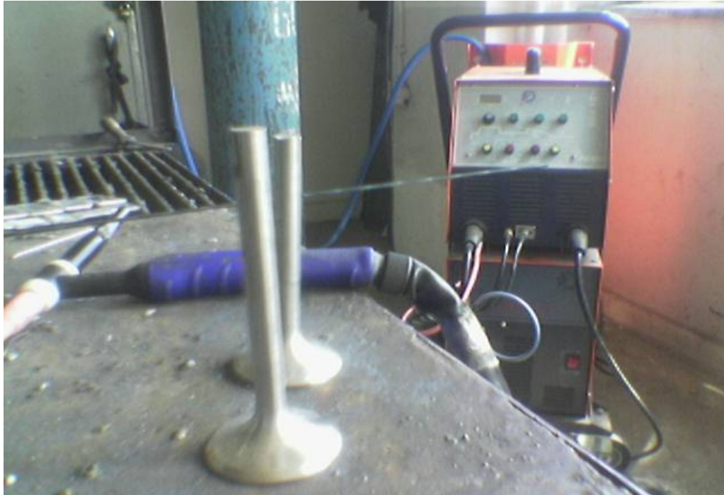
Resim 7.1. Supapların kaynak öncesi görüntüleri.
