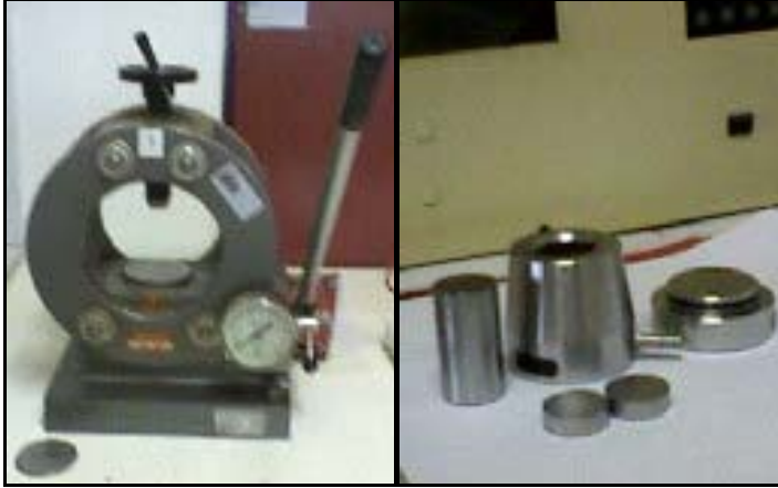
Resim 3.6. Pres ve dye takımı.
