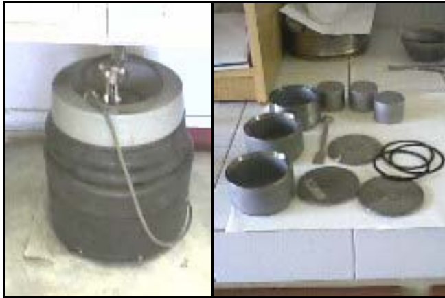
Resim 3.5. Spex markalı değirmen ve çelik hazneler.
