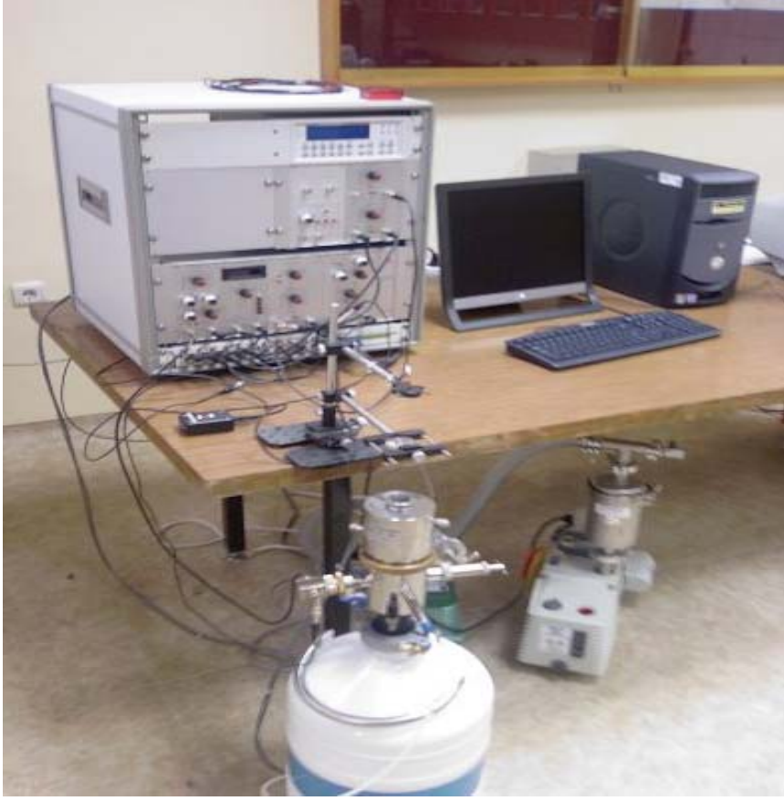
Resim 3.5. DLTS ölçümleri için kullanılan deney düzeneği
