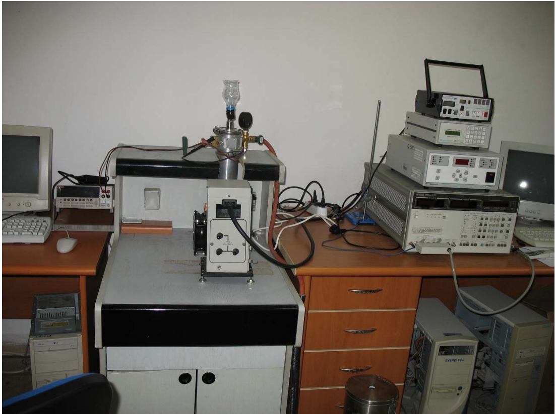
Resim 3.4. Sıcaklık bağımlı I-V ve C-V ölçümleri için kullanılan deney düzeneği
