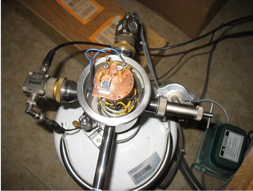
Resim 3.6. DLTS cihazında numune tutucuya yerleştirilen numunenin görüntüsü
