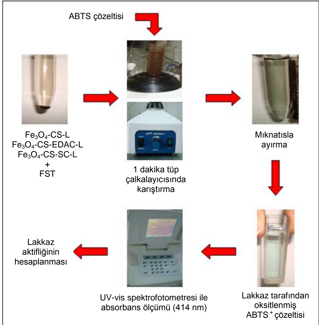
Şekil 3.7. Fe_3O_4 -CS nanoparçacıklarına immobilize edilen lakkazların aktiflik tayinindeki işlem basamakları
