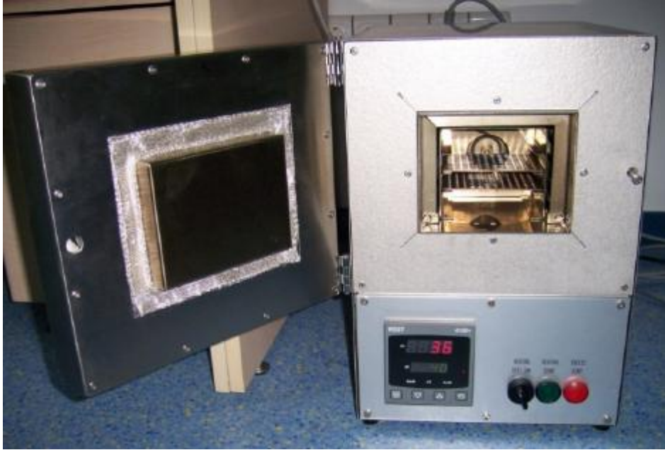
Resim 4.7. PTW marka TLDO model TLD fırını
