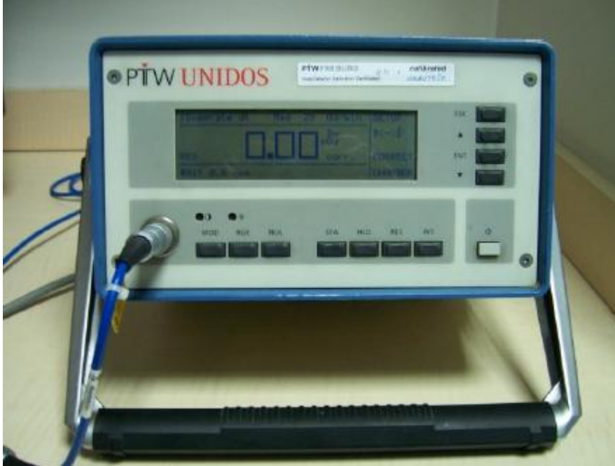
Resim 4.4. PTW marka unidos elektrometre
