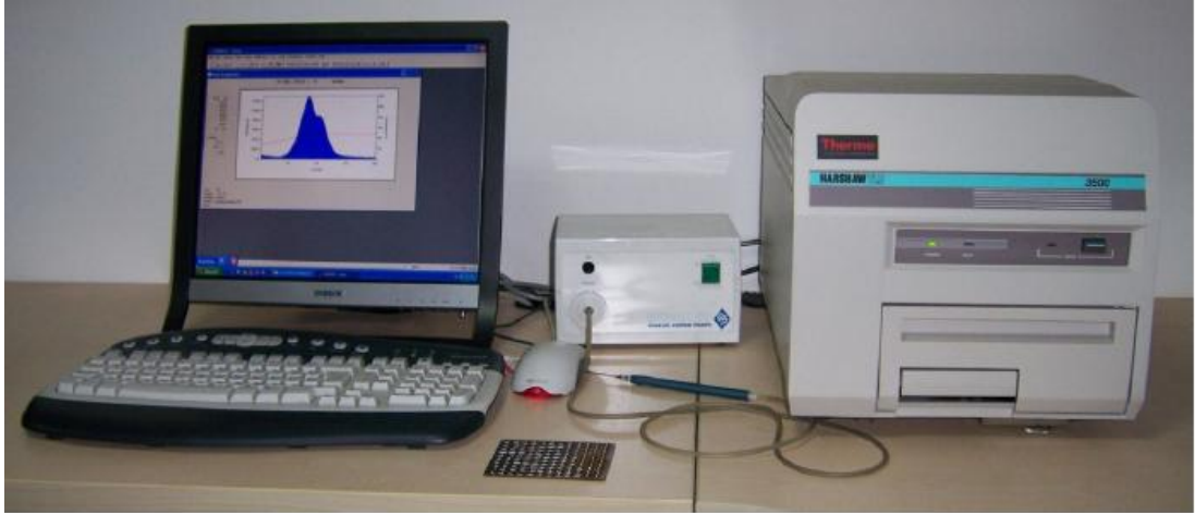
Resim 4.6. Harshaw marka 3500 model TLD okuyucusu
