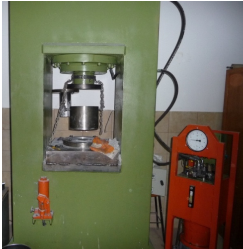
Resim 3.2. AA2024 numunelere soğuk deformasyon uygulanan 250 ton kapasiteli pres
