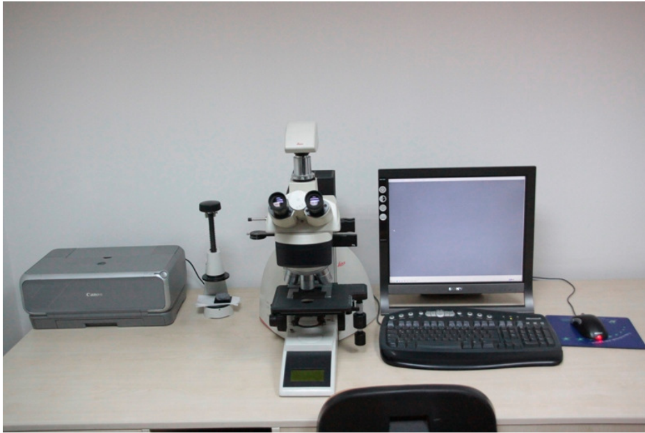
Resim 3.7. Mikroyapıların görüntülenmesinde kullanılan optik mikroskop.
