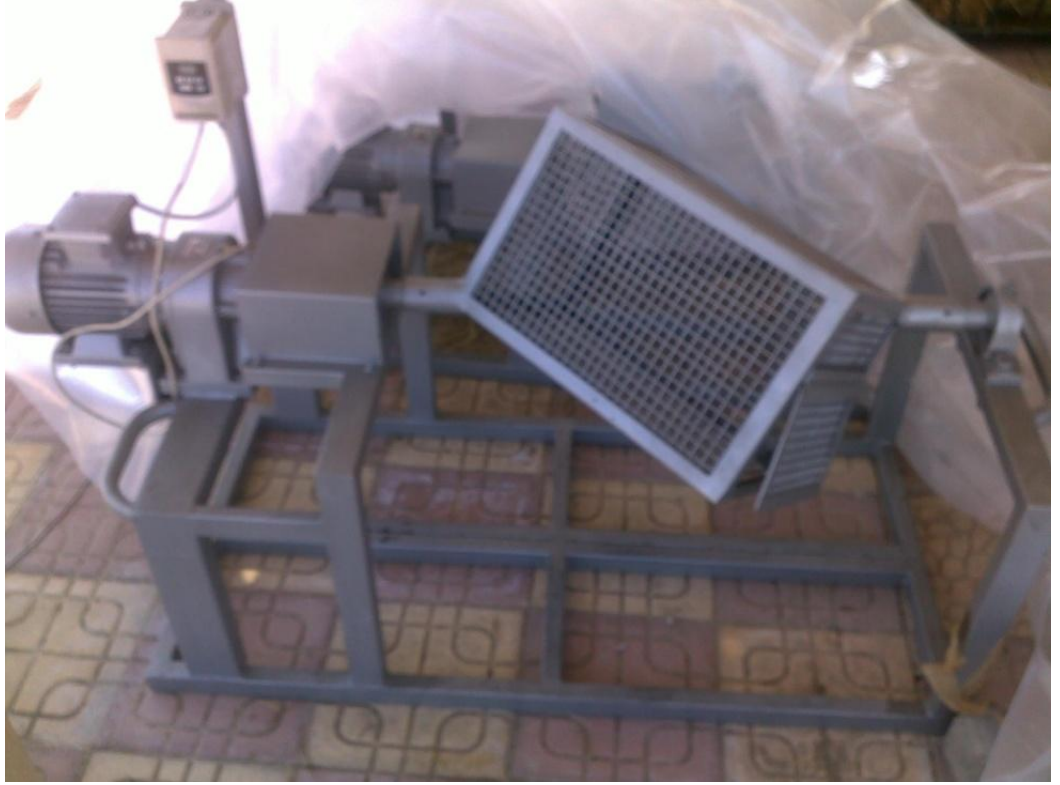
Şekil 3.7. Briketlerin düşme-dayanıklılık dirençlerinin belirlenmesinde kullanılan test ünitesi
