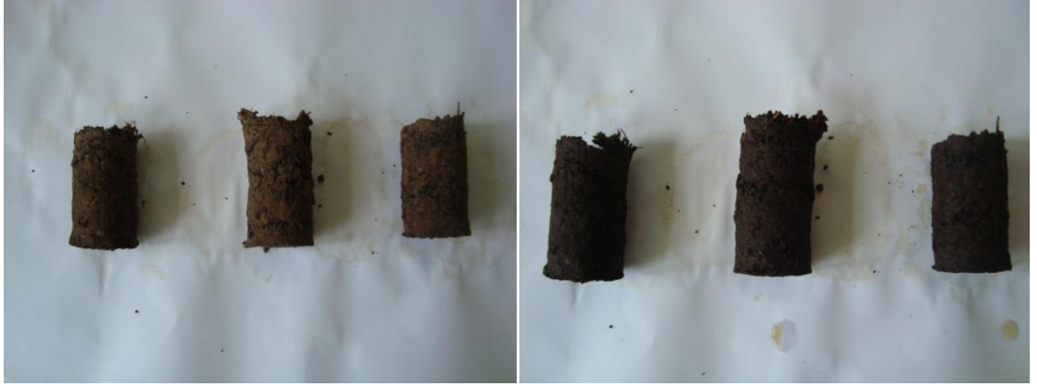
Şekil 4.11. Y karışımı ve A tipi briketlerin su alma direnci öncesi ve sonrası görünümleri
