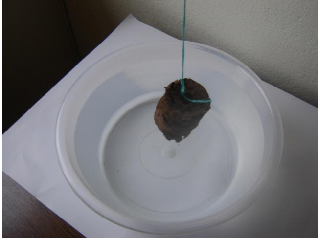
Şekil 3. 8. Su alma direnci için briketlerin suya daldırılması
