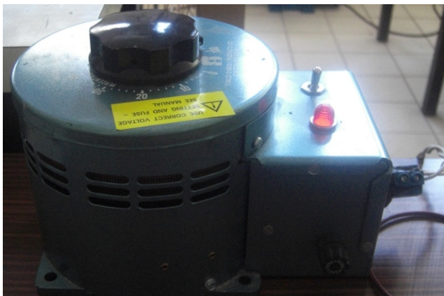
Şekil 4.13. Deneylerde kullanılan ayarlanabilir transformatörün (varyak) görünümü
