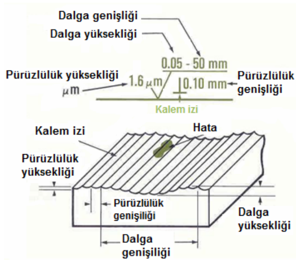
Őekil 4.9. Yüzey pürüzlülüęü karakteristikleri [158]
