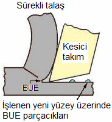
Şekil 4.5. Yığıntı talaş biçimi (BUE) [154]
