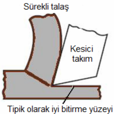
Şekil 4.3. Sürekli talaş biçimi [154]
