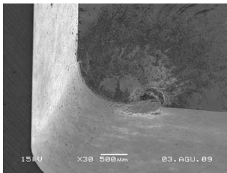
Resim 6.10. %15 MgO kodlu numunenin SK takım ile işlenmesinde oluşan SEM görüntüleri (V=150 m/min f=0,225 mm/rev)
