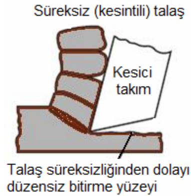
Şekil 4.4. Kesikli talaş biçimi [154]
