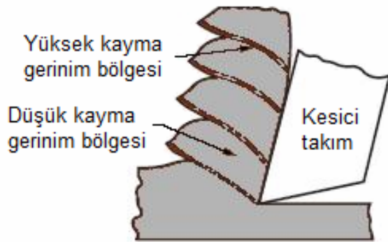
Şekil 4.6. Yarı kesintili talaş biçimi [154]
