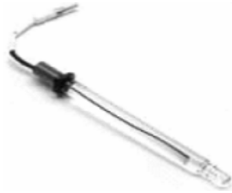
Resim 3.3. Ag/AgCl (3 M NaCl) referans elektrot
