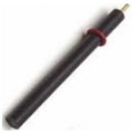
Resim 3.2. Camsı karbon elektrot
