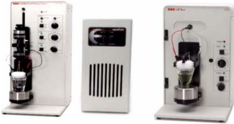
Resim 3.1. BAS model elektrokimyasal analizör
