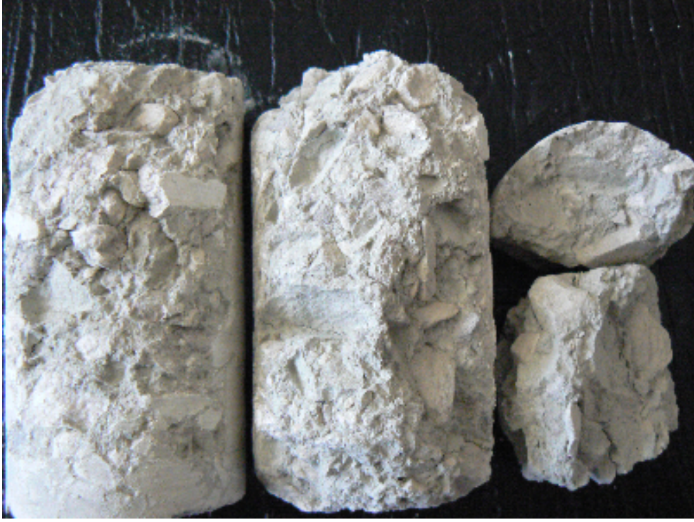
Resim 4.13. 800 °C yüksek sıcaklık uygulanarak havada soğutulan örnek
