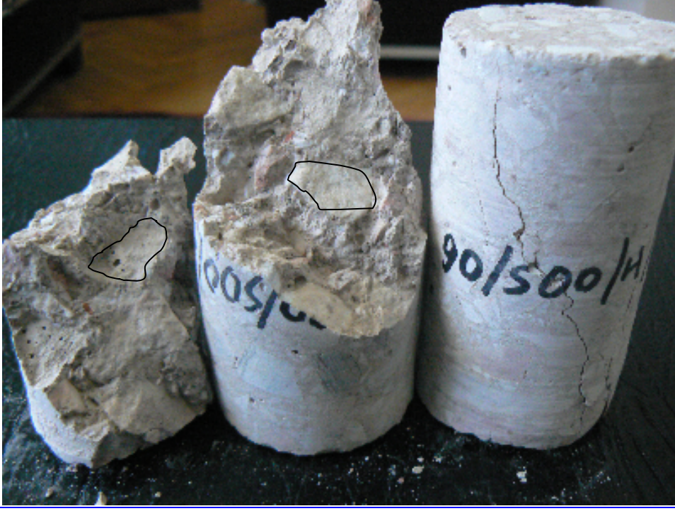
Resim 4.7. 500 °C yüksek sıcaklık uygulanarak havada soğutulan örnek
