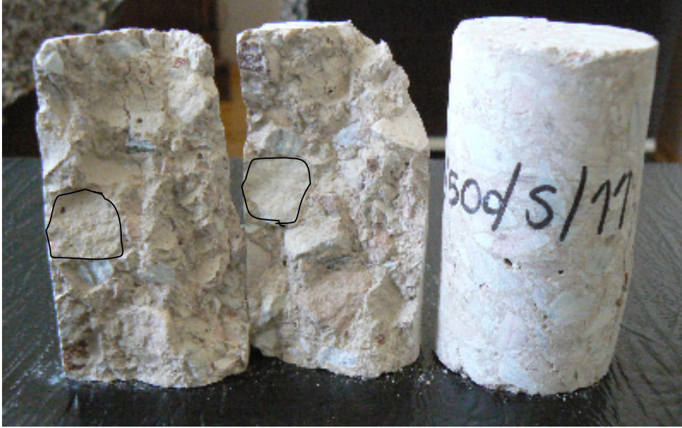
Resim 4.8. 500 °C yüksek sıcaklık uygulanarak suda soğutulan örnek
