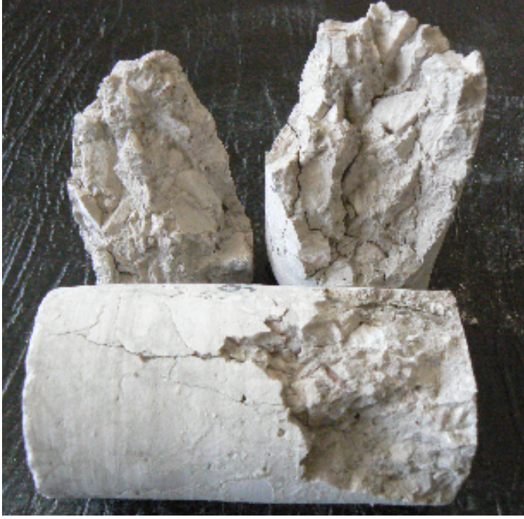
Resim 4.11. 700 °C yüksek sıcaklık uygulanarak havada soğutulan örnek
