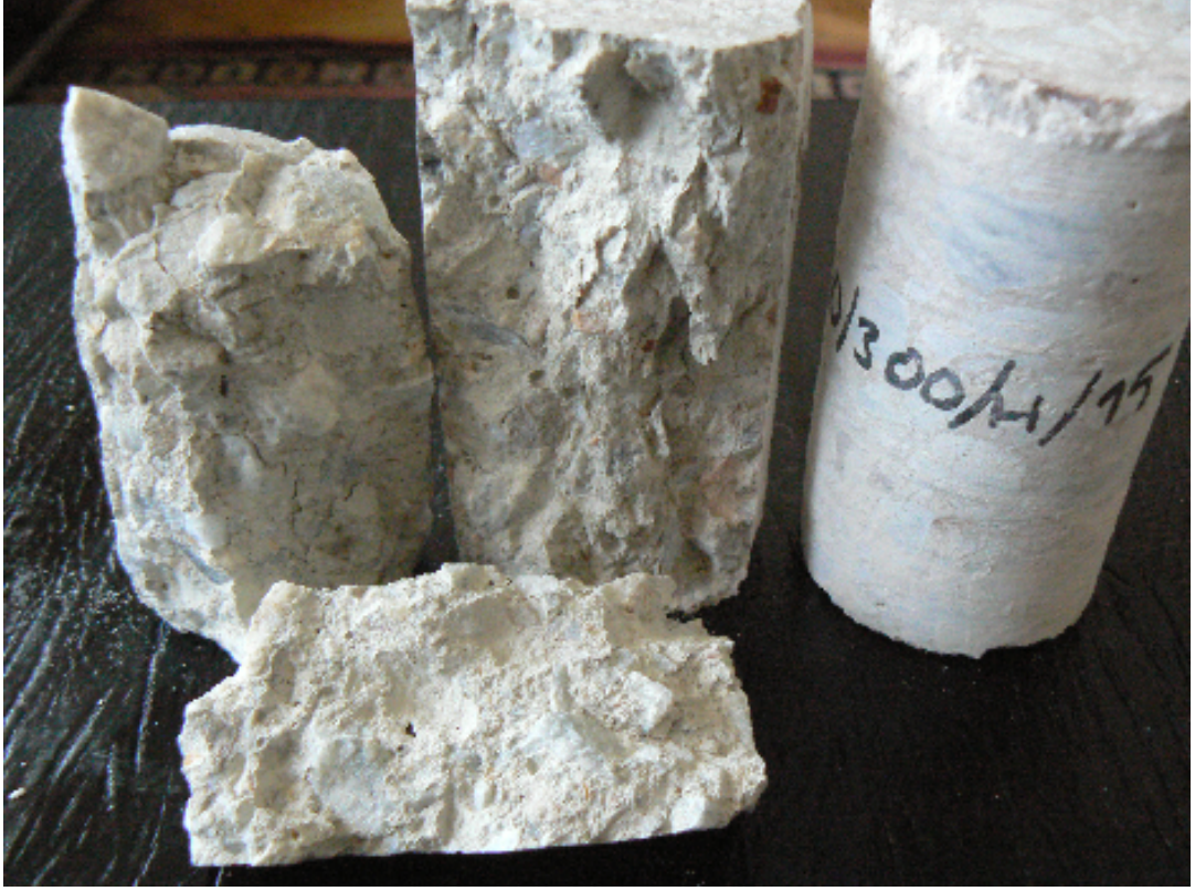
Resim 4.5. 300 °C yüksek sıcaklık uygulanarak havada soğutulan örnek
