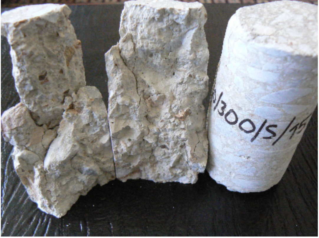
Resim 4.6. 300 °C yüksek sıcaklık uygulanarak suda soğutulan örnek
