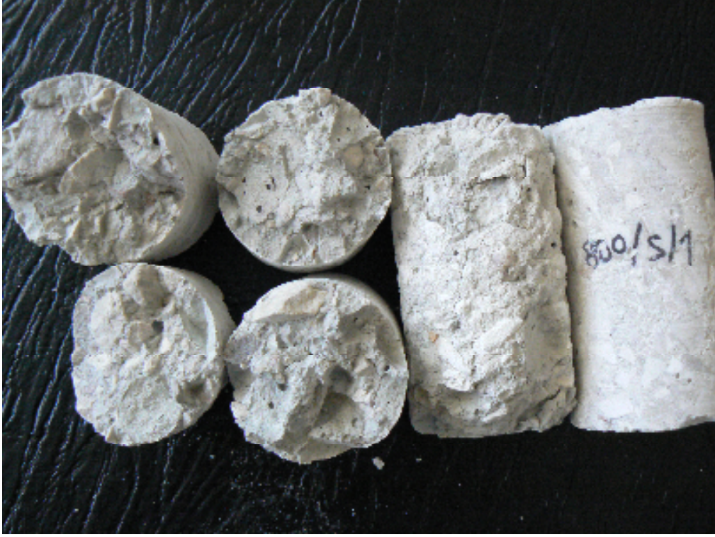
Resim 4.14. 800 °C yüksek sıcaklık uygulanarak suda soğutulan örnek
