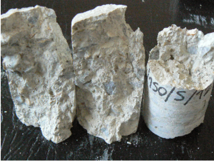
Resim 4.4. 150 °C yüksek sıcaklık uygulanarak suda soğutulan örnek
