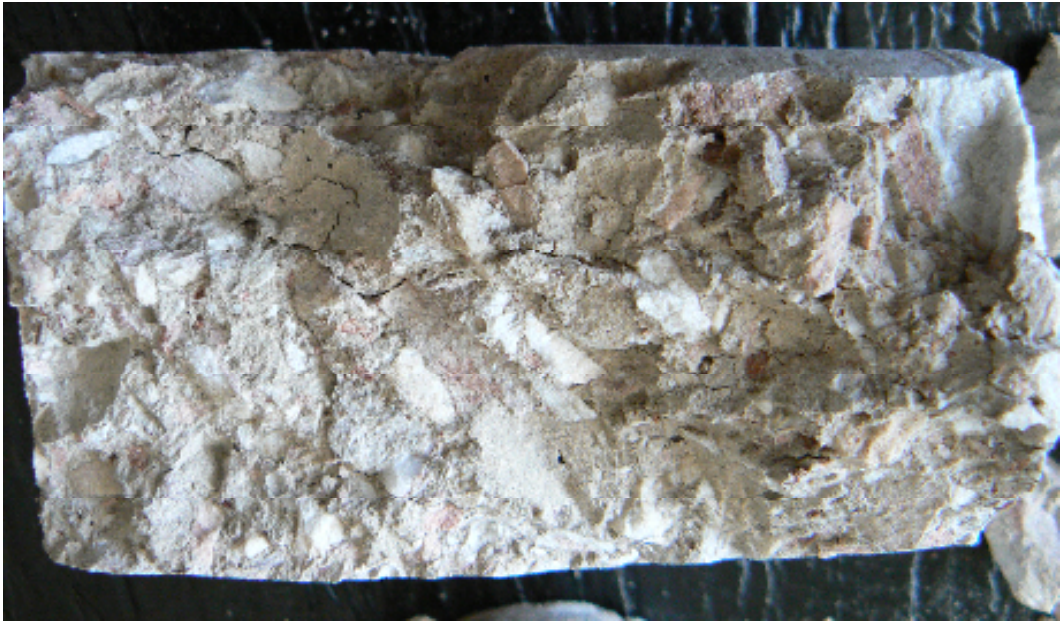
Resim 4.12. 700 °C yüksek sıcaklık uygulanarak suda soğutulan örnek
