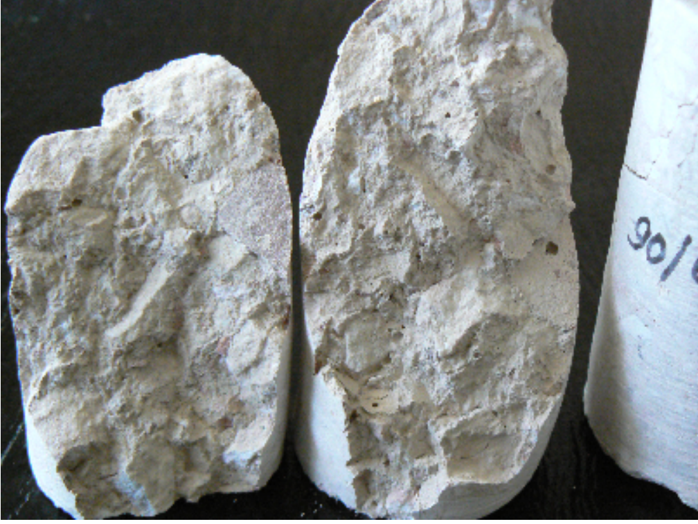
Resim 4.9. 600 °C yüksek sıcaklık uygulanarak havada soğutulan örnek
