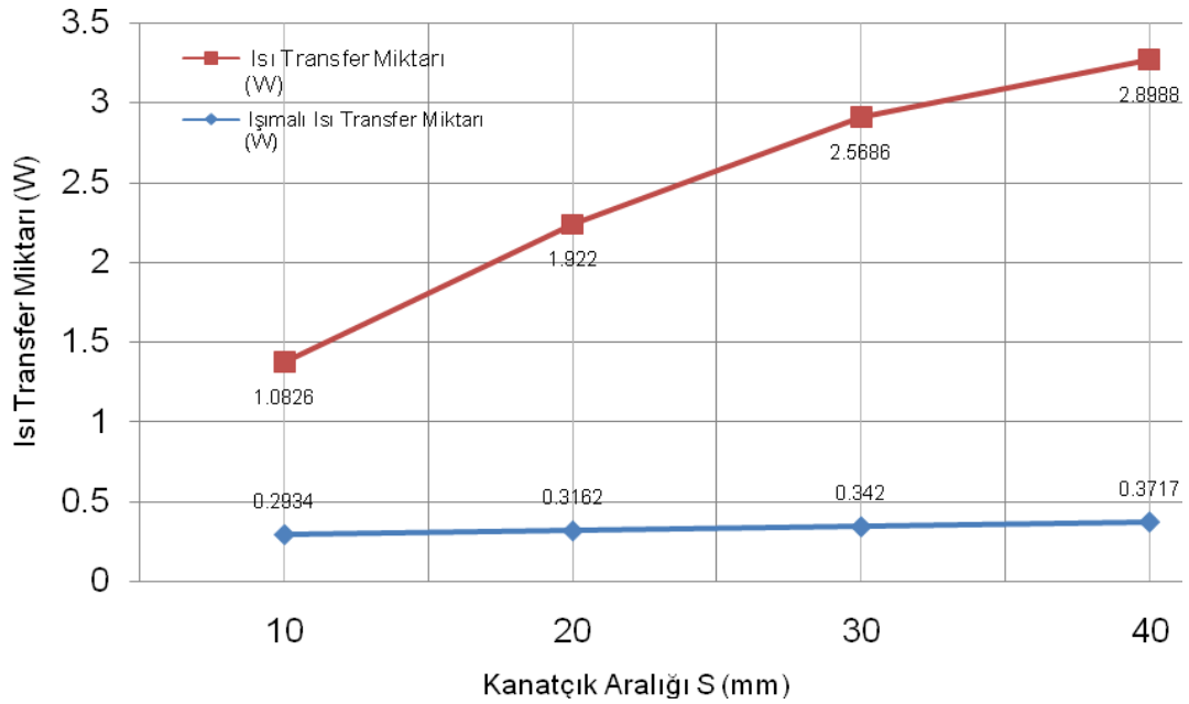
Şekil 5.56. Işımalı kanatçık yüksekliği H=25 mm, kanatçık boyu L=62.5 mm ve \Delta T=50 K için farklı kanatçık aralığı S (mm) değerlerinde ısı transfer miktarı
