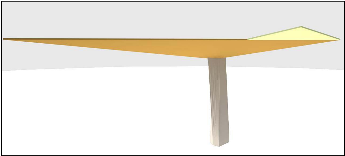
Şekil 3.9. Rixos Grand Ankara büyük markizin 17 metre 28 cm. uzunluğundaki konsolu, [Koç, 2006]
