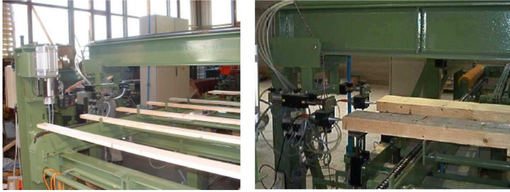
Resim 2.3. İki çift dönüştürücülü ultrasonik modül resimde görülmektedir. Süreci arttırmak için yeni dönüştürücüler eklenebilir.
