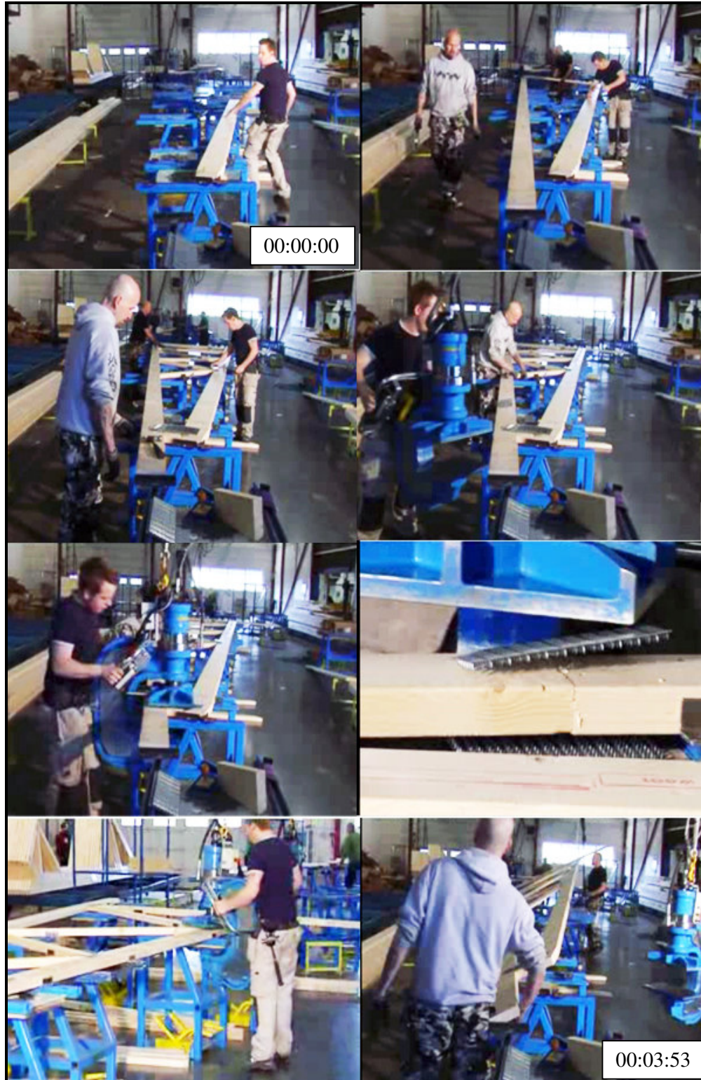
Resim 3.2. Kafes elemanlarının tezgahlarda çivili metal elemanlarla preslenmesi
