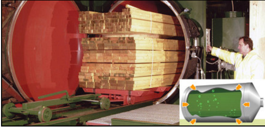
Resim 2.2. Emprenye maddesinin kazanlar içinde basınç yoluyla ahşaba uygulanması metodu
