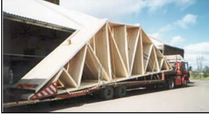
Resim 3.4. Ahşap kafeslerin şantiyeye nakliyesi
