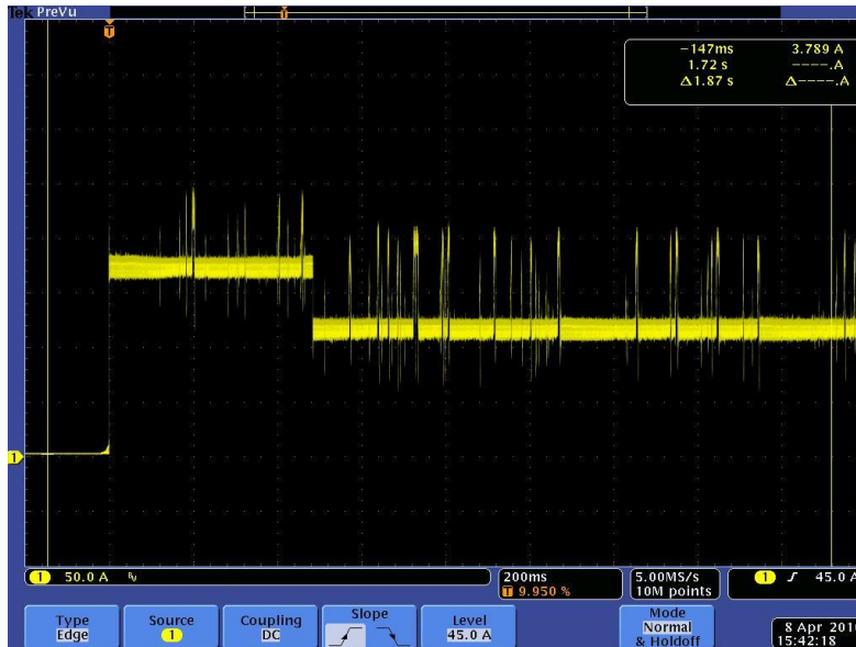
Şekil 7.10 Destekli ark (tam destek) çalışması. 200 A akım darbeleri
