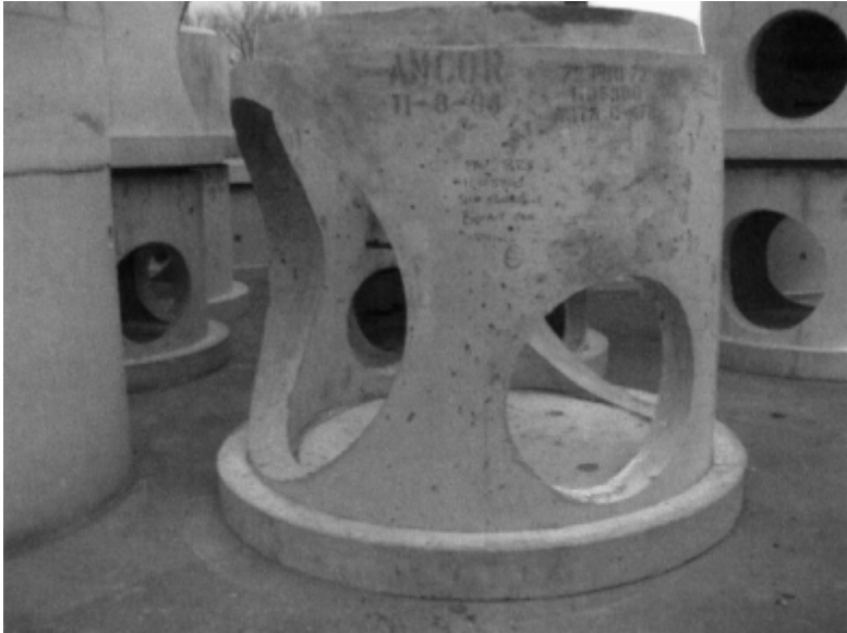
Resim 4.2. Yüksek düzeyde bağlayıcı ve %60 oranında uçucu kül içeren beton kullanılarak üretilen prekast menhol [Reiner ve Rens, 2006]
