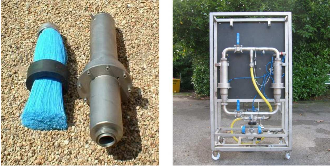
Resim 3.9. Fibrer-filtre filtreleme sistemi ve paralel bağlanmış ikili arıtma sistemi [Graham, 2004].
