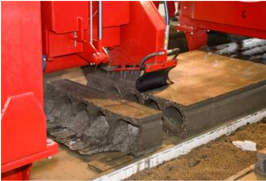
Resim 3.5. Prekast boşluklu döşeme paneli, soğutucu olarak su kullanılarak boyutlandırma işlemi [Spiroll, 2010]
