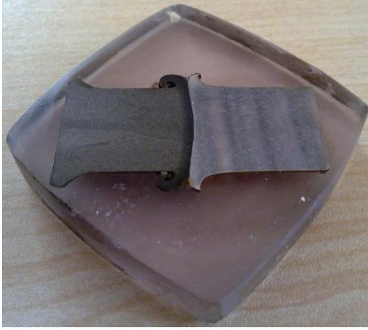
Resim 6.4. Polyester reçineye soğuk gömme yapılmış numune
