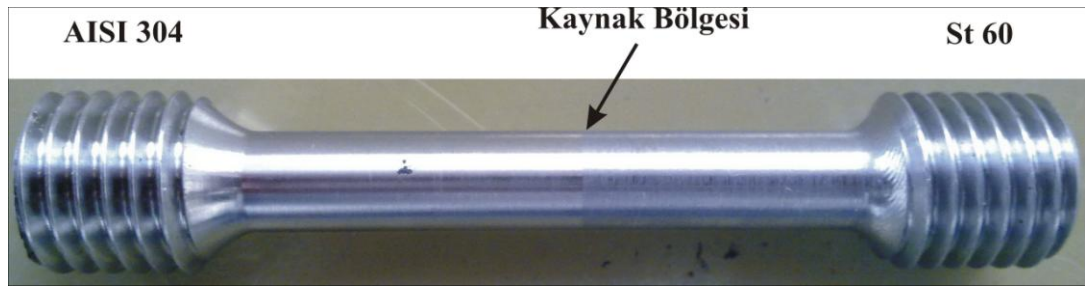
Resim 6.8. Çekme numunesi fotoğrafı
