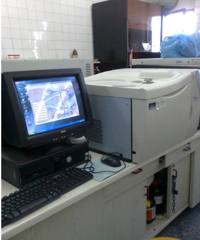
Resim 3.7. Analizlerde kullanılan gaz kromatografisi cihazı
