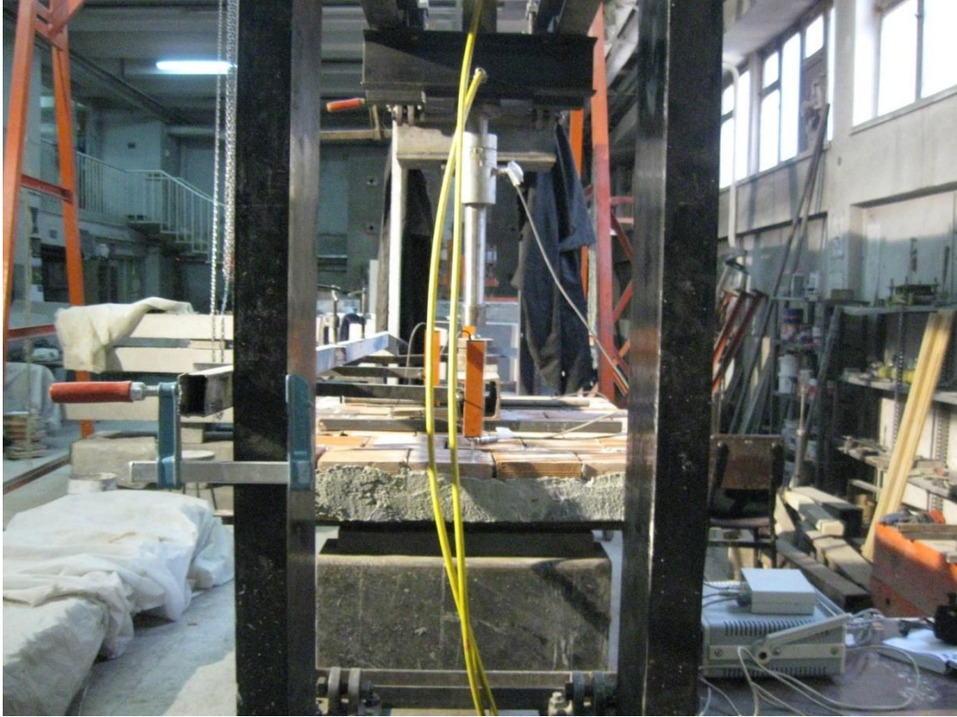
Resim 3.1. Kapalı çerçeve sistem ve yükleme düzeneği
