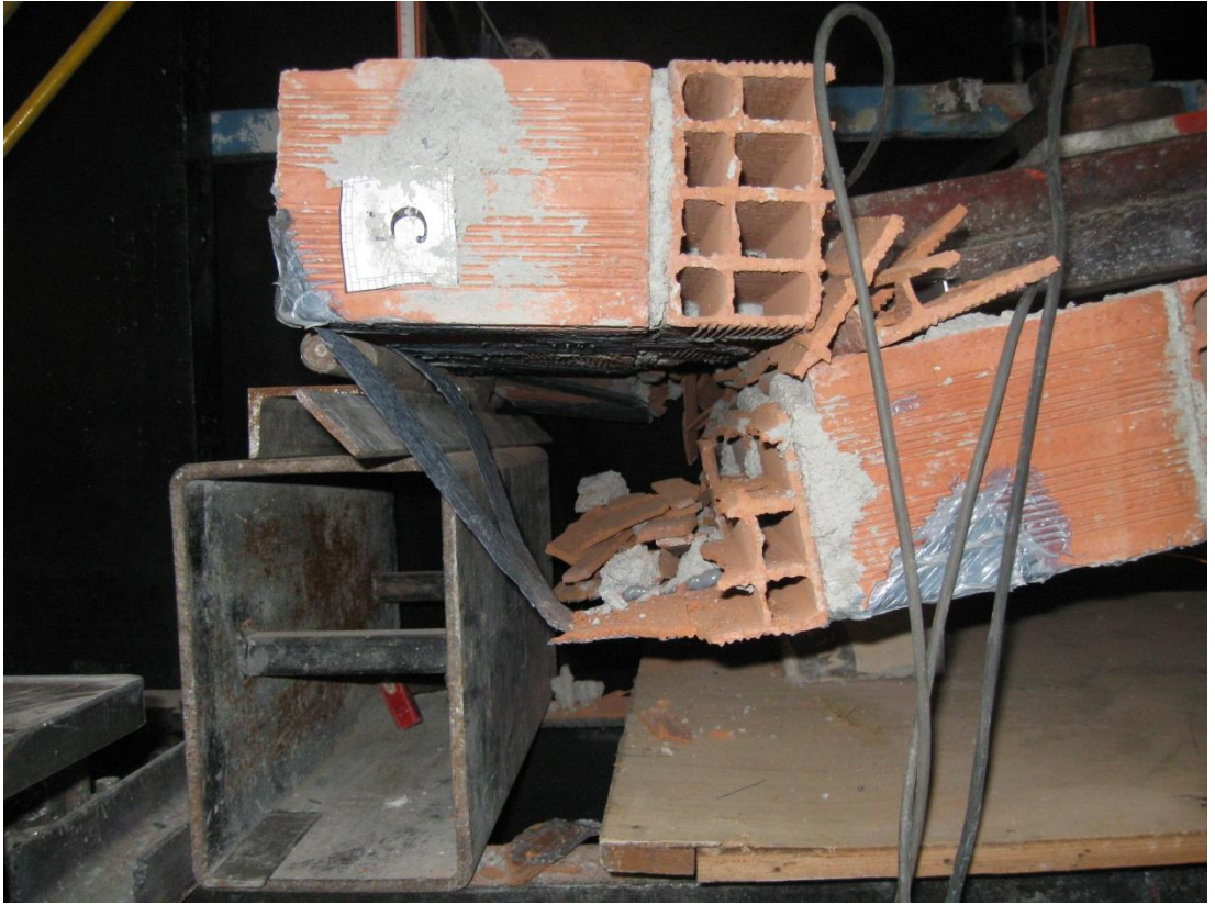
Resim 4.15. Kesme kırılması ve CFRP şeritlerin yüzeyden ayrılmaları
