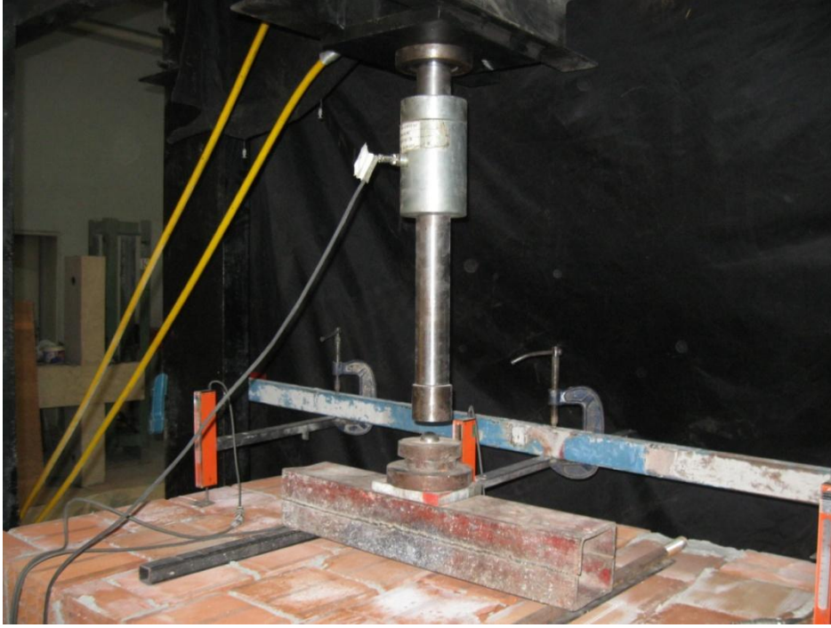
Resim 3.2. Yük hücresi ve yükleme kirişi
