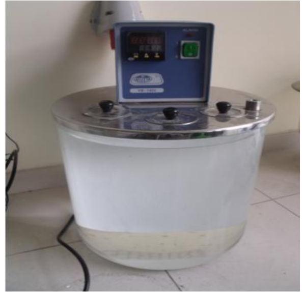
Şekil 8.2. Ubbelohde viskozimetresi Resim 8.2. Ubbelohde viskozimetre düzeneği
