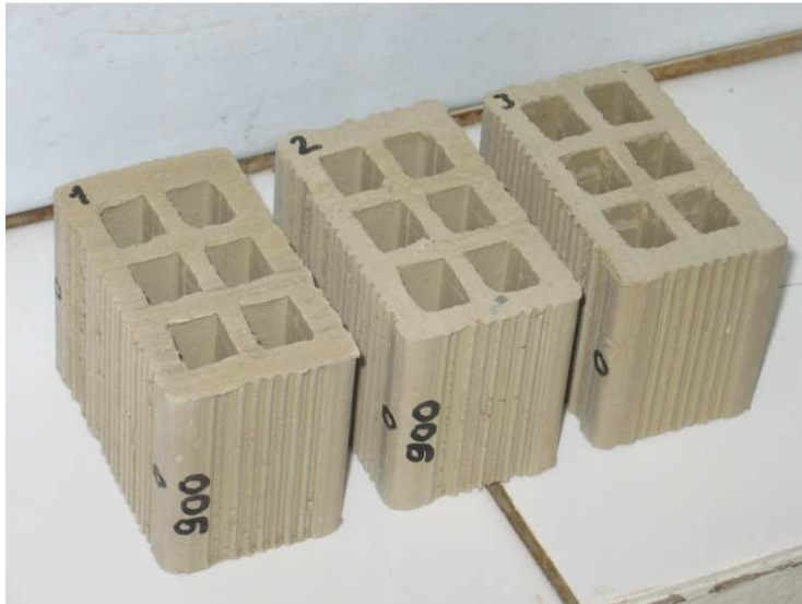
Resim 4.4. Ekstrüzyonda şekillendirilen tuğlalar
