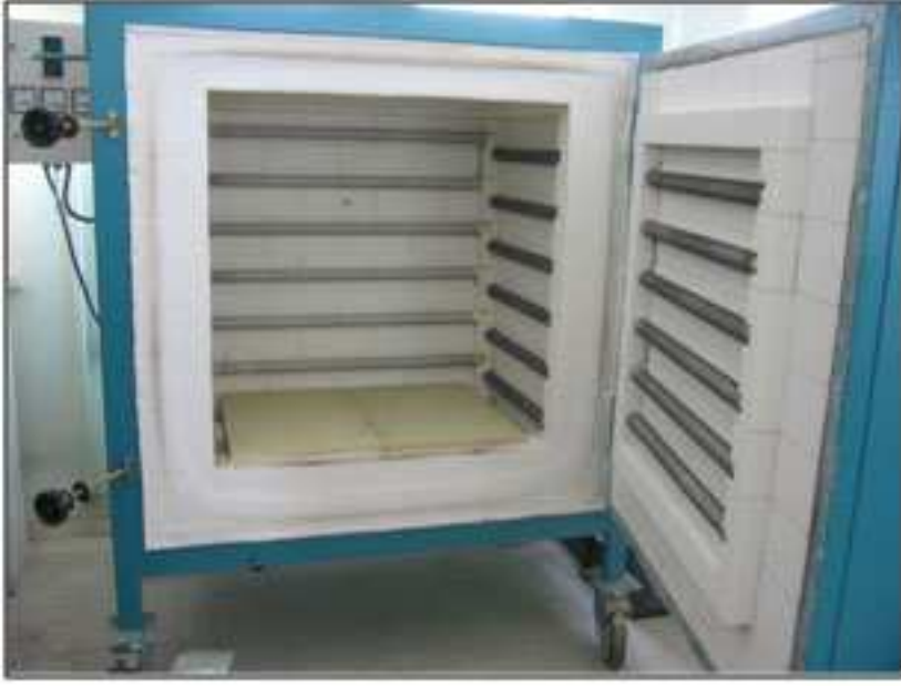
Resim 4.5. 1200  C piřirme kapasitesi bulunan laboratuvar tipi elektrikli fırın
