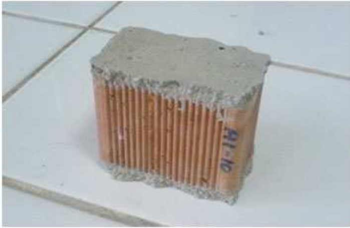
Resim 4.7. Tuğlanın iki taraflı çimento harcı başlıklaması
