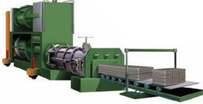
Resim 3.3. Ekstrüzyonda tuğla üretimi ve kesilmesi [İnternet-4, 2006]
