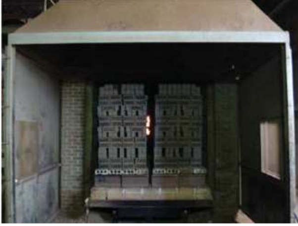
Resim 3.4. Tuğlaların pişirilmesi [İnternet-3, 2006]
