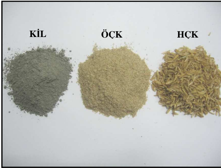
Resim 4.1. Kullanılan malzemeler; kil, öğütülmüş çeltik kavuzu (ÖÇK), ham çeltik kavuzu (HÇK)
