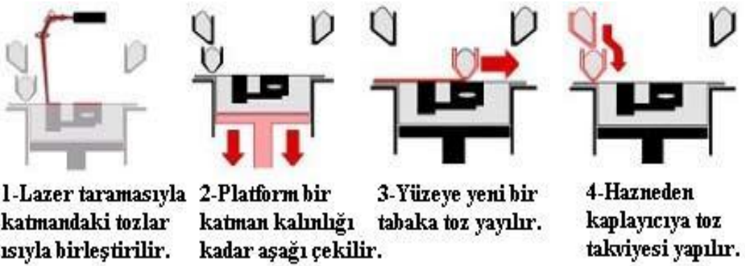
Şekil 3. 7. SLS HPÜ yönteminin çalışma prensibi [2]
