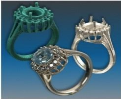
Şekil 3. 15. Mücevher tasarım ve imalat uygulamasının aşamaları [1, 9]
