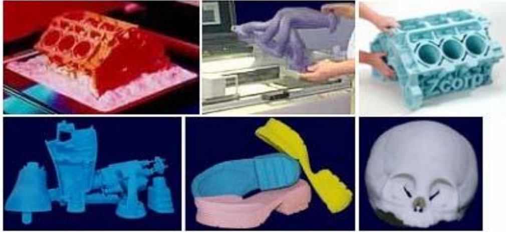
Resim 3. 3. Yapıştırıcı ile toz bağlama HPÜ yöntemi ile yapılan model [33]
