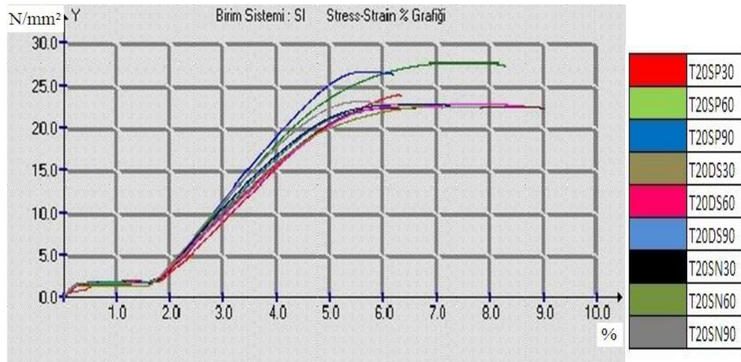
Şekil 5. 9. T20 uç tipi ile üretilen modellerin % uzama / dayanım grafiği
