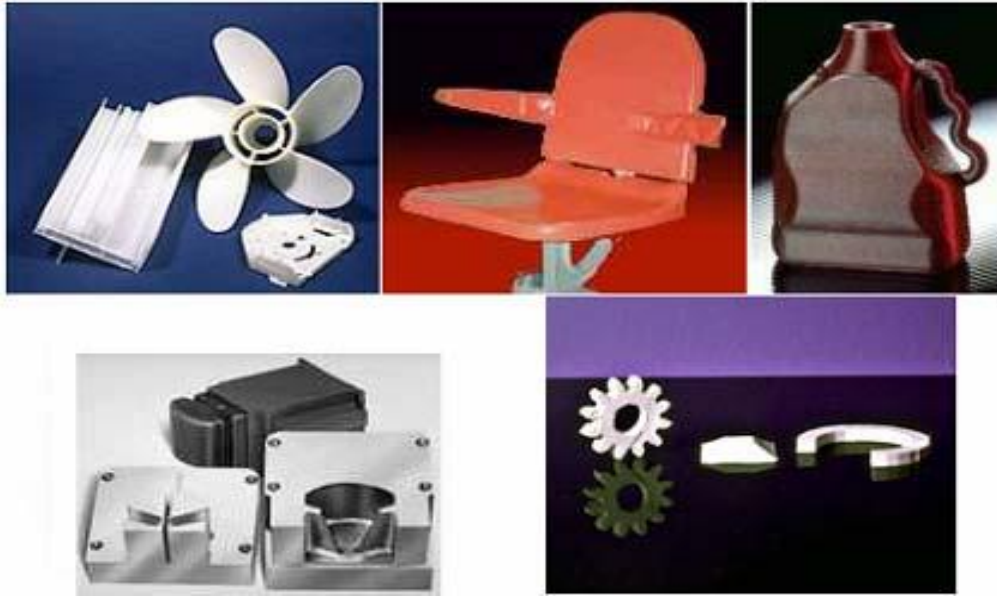
Resim 3. 8. Dimension 3D Printer model HPÜ cihazı ile üretilen modeller [1]
