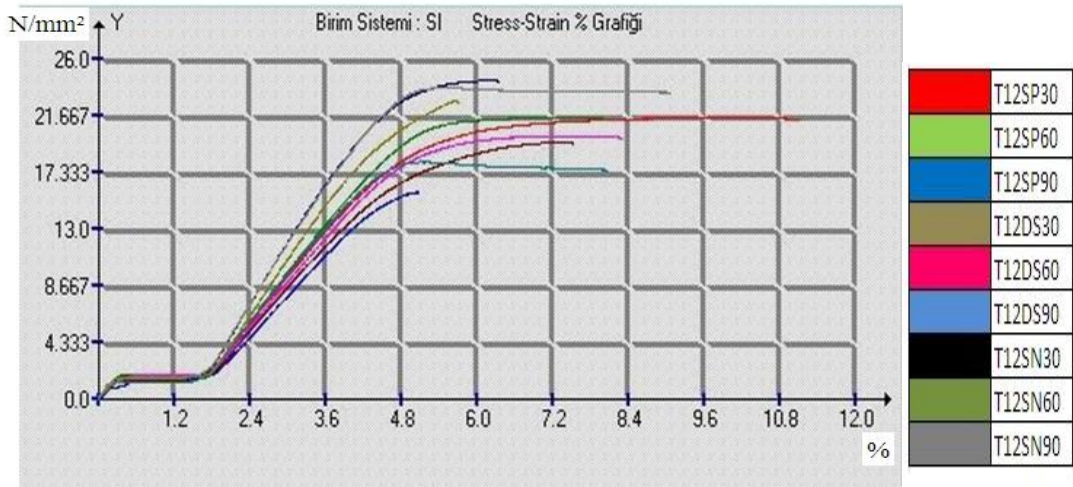
Şekil 5. 7. T12 uç tipi ile üretilen modellerin % uzama / dayanım grafiği
