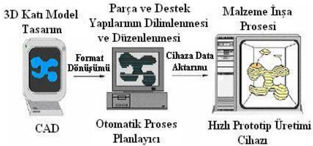
Şekil 3. 1. HPÜ sisteminde genel aşamalar [2, 9]
