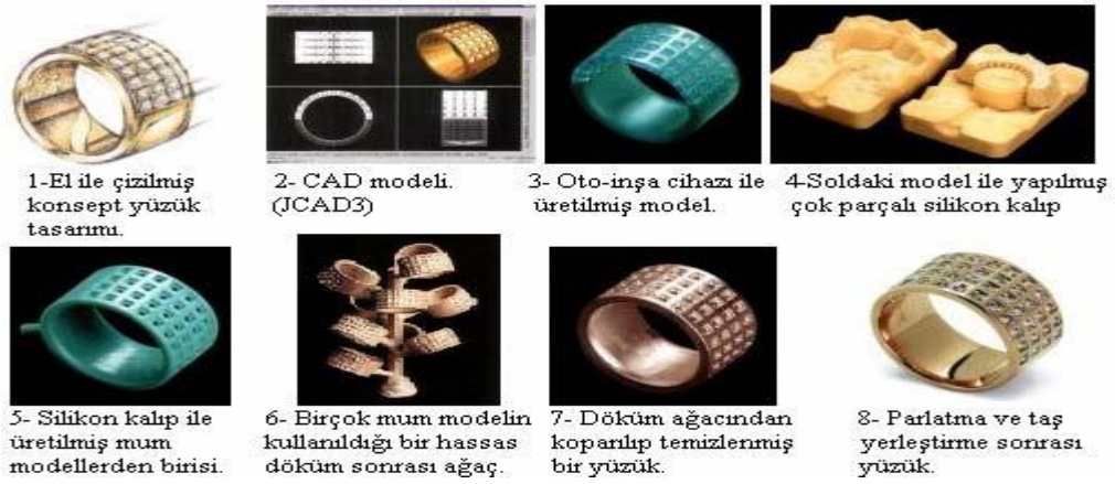
Şekil 3. 15. Mücevher tasarım ve imalat uygulamasının aşamaları [1, 9]
