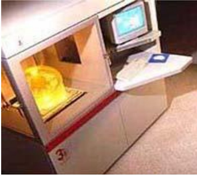
Resim 3. 4. 3D SYSTEM SLA 7000 model HPÜ Cihazı [2]
