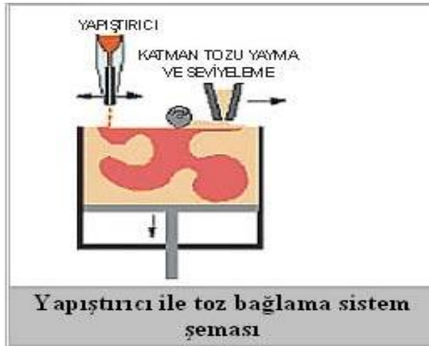
Şekil 3. 8. Yapıştırıcı ile toz bağlama HPÜ yönteminin çalışma prensibi [2]
