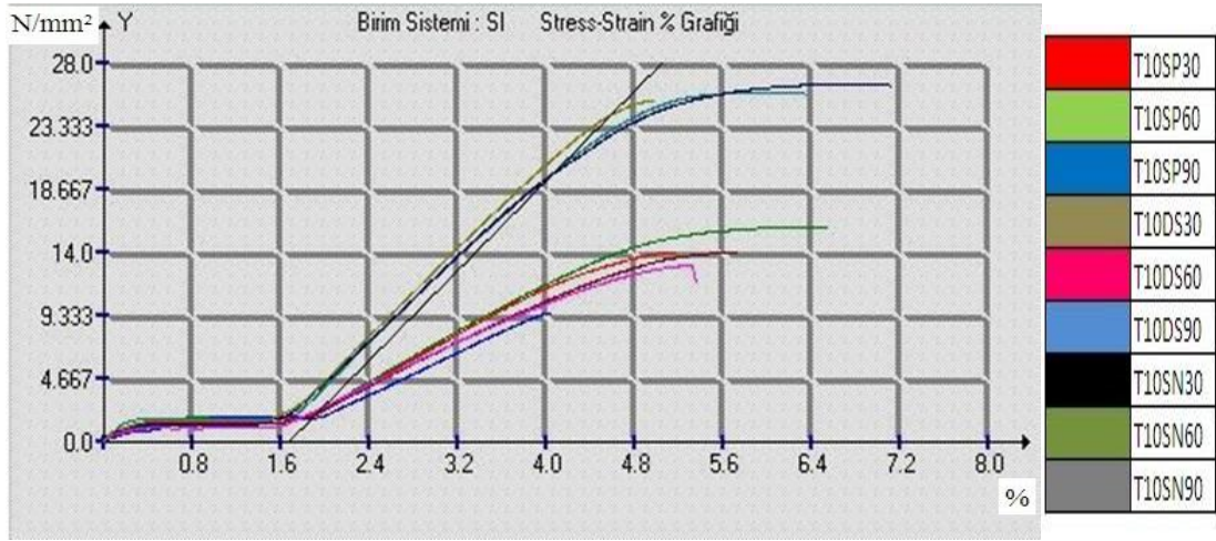
Şekil 5. 6. T10 uç tipi ile üretilen modellerin % uzama / dayanım grafiği
