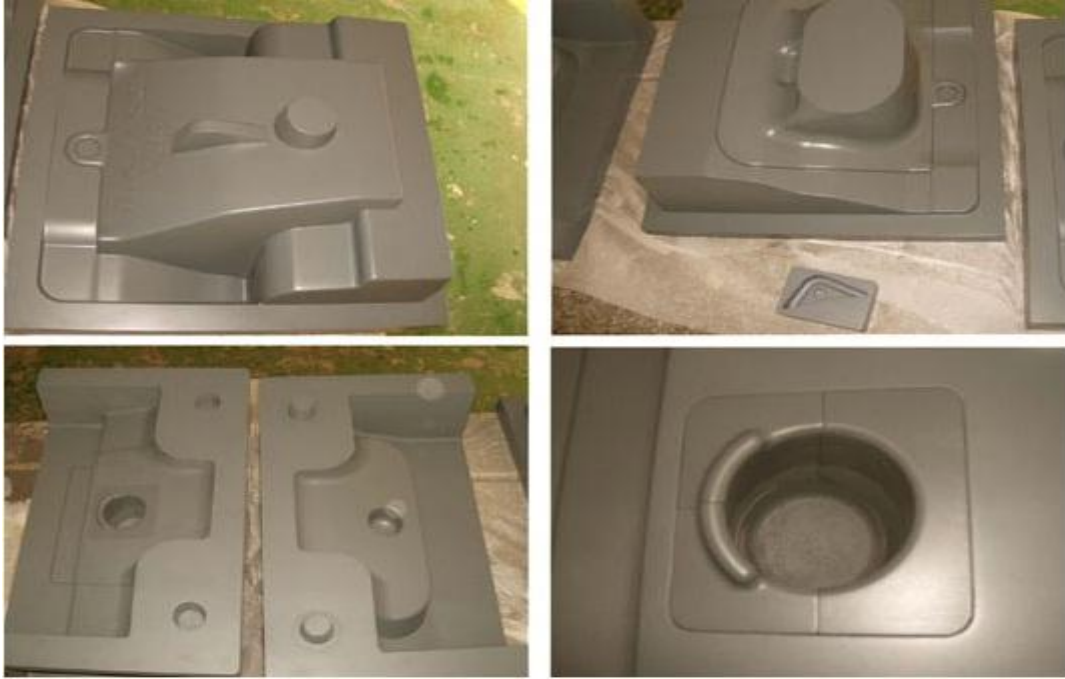
Resim 3. 11. Prototipleme yöntemi ile elde edilmiş kalıp modelleri [28,29]
