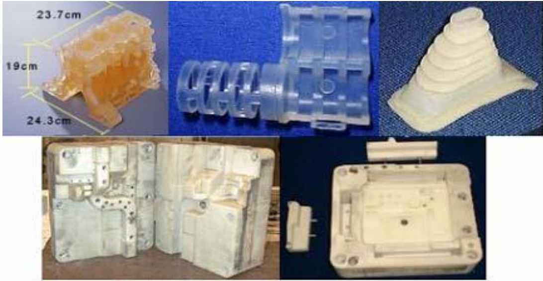
Resim 3. 5. Yapıştırıcı ile toz bağlama HPÜ tekniği yapılan kalıp modelleri [2]
