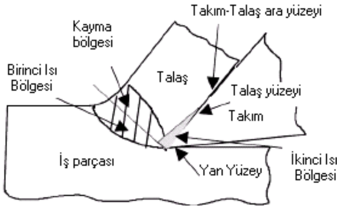
Şekil 3.7. Talaş kaldırma işleminde oluşan ısı üretim bölgelerinin gösterilmesi [5,43]
