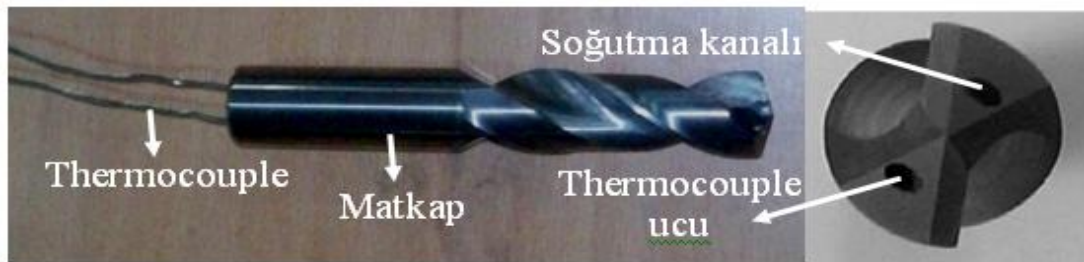
Resim 5.2. Soğutma delikleri boyunca ısı çifti yerleştirilmiş matkap
