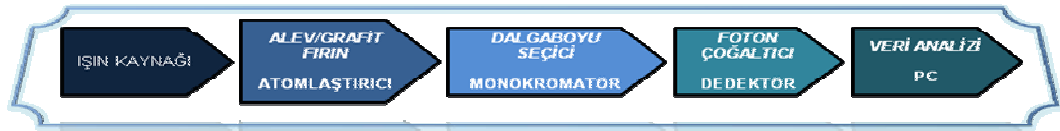
Şekil 2.6. Atomik Absorpsiyon Spektrofotometre (AAS) cihazı blok diyagramı
