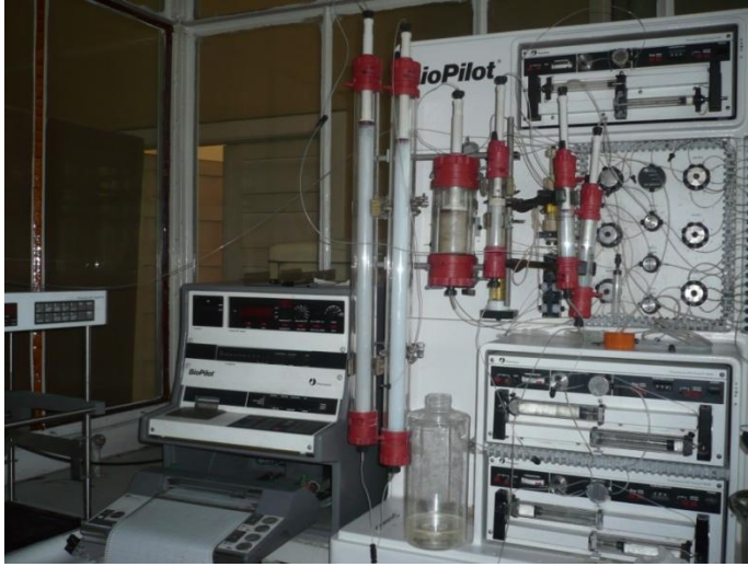
Resim 3.2. Bioplot Pharmacia FPLC ve fraksiyon kollektörü
