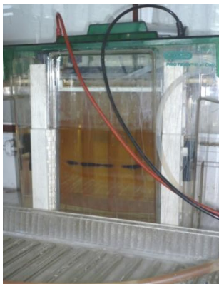
Resim 3.3. Örneklerin %10'luk SDS-PAGE'de yürütülmesi
