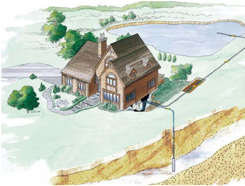
Şekil 3.6. Yer altı su kaynaklı ısı pompası uygulaması.
