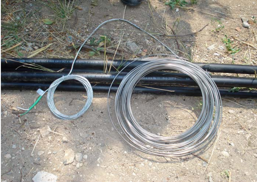
Resim 4.5. Toprak altı sıcaklığını ölçmek için kullanılan termokupl
