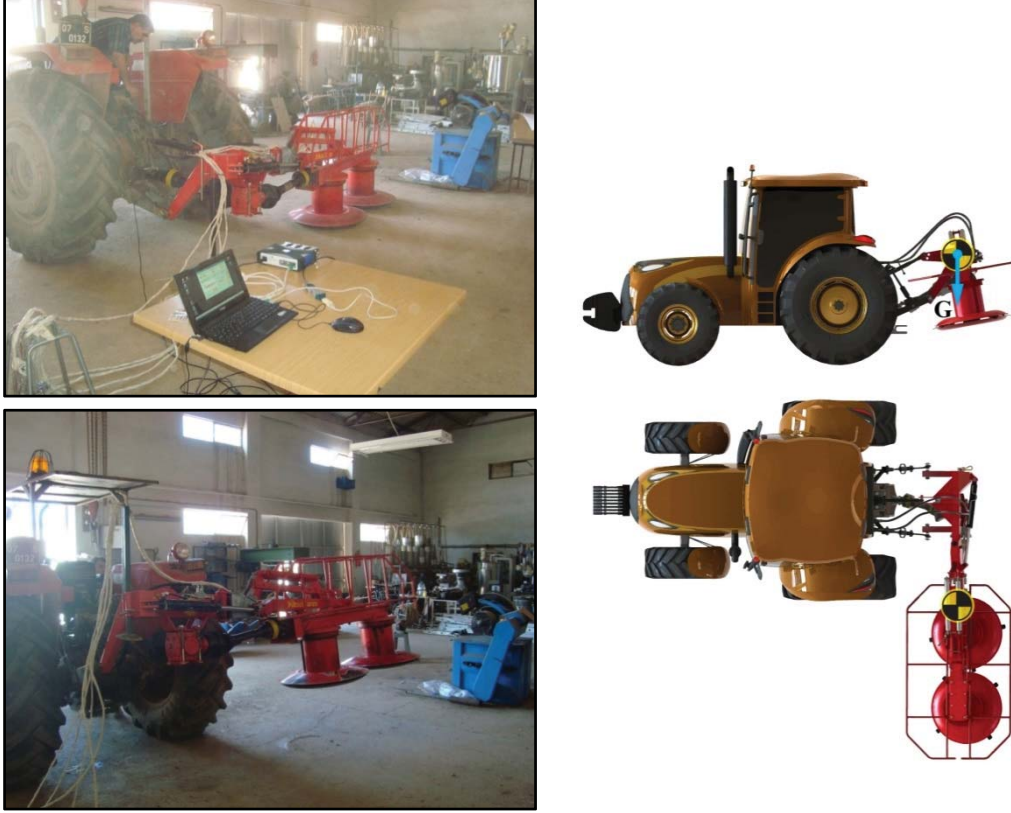
Şekil 4.40. TÇBM iş pozisyonu askı konumu testleri
