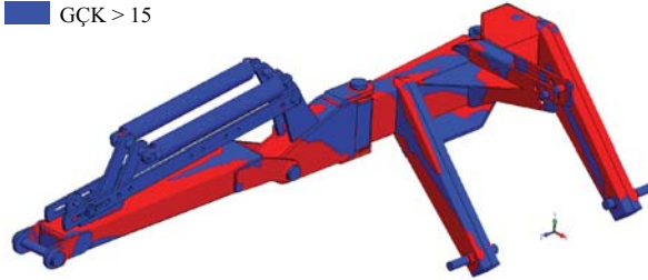
Şekil 4.32. İş pozisyonu hasat konumu farklı GÇK dağılımlarını gösteren FEA çıktıları
