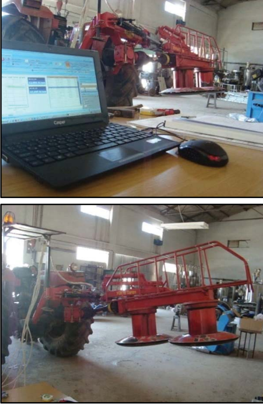
Şekil 4.41. TÇBM yol pozisyonu askı konumu testleri
