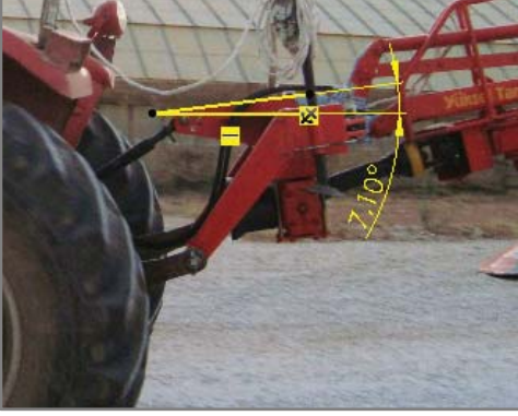
Şekil 4.22. TÇBM askı konumu yatayla yaptığı açı
