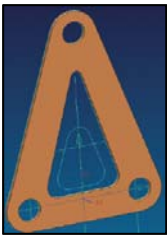
Şekil 2.47. Sırasıyla çeki demiri kolu ve destek elemanı için optimizasyon sonrası elemanlara ait değerlendirmeler
