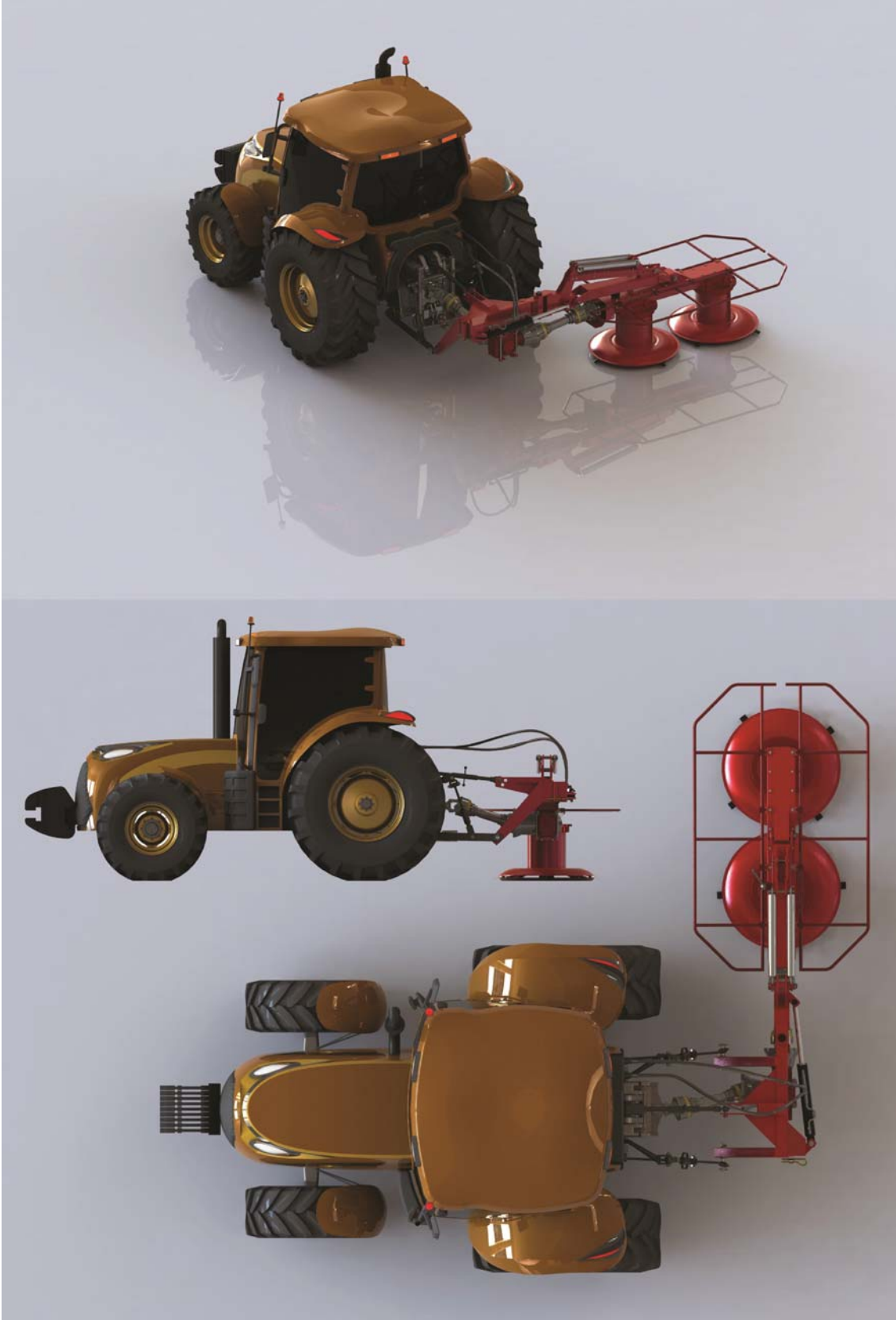
Şekil 4.6. TÇBM-traktör montajı (İş konumu)
