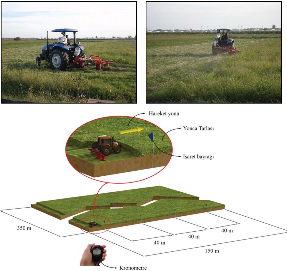
Şekil 4.46. TÇBM iş pozisyonu hasat konumu testleri
