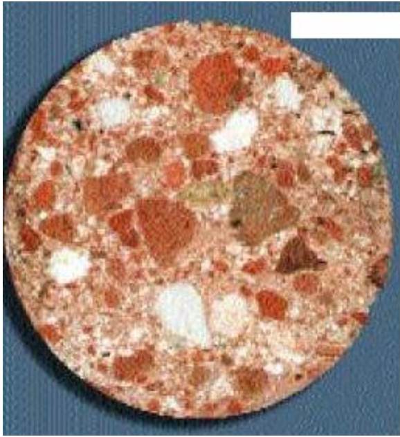
Resim 2.2. Horasan harcının makro yapısını gösteren kesit görüntüsü, harç içindeki tuğla kırığı ve doğal agrega birlikte kullanılmıştır [18]
