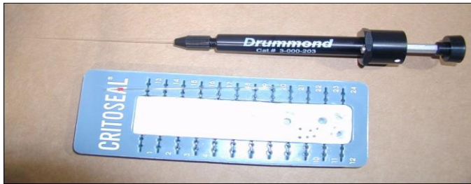
Resim 7.1. Kapiller tüp ve enjektör ile nokta kaynak hazırlanması
