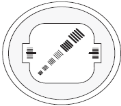
Şekil 8.2. QA fantomunun yüksek kontrastlı çözünürlük, kontrast ölçeği, kesit kalınlığı ve lazer hassasiyeti ölçülmesine yarayan bölümü
