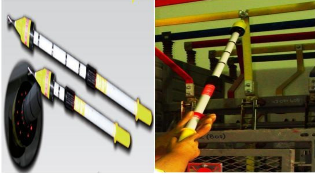
Resim 2. 5. Yüksek gerilim kontrol kalemi ve kullanılışı
