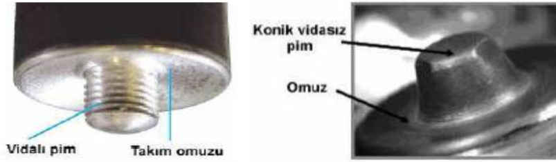
Resim 4.3. Sürtünme karıştırma nokta kaynağı (FSSW) uygulamalarında kullanılan takımlardan örnekler [21]
