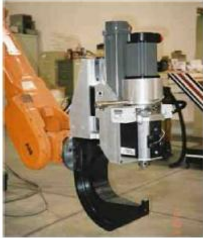
Resim 4.7. Bir Amerikan kuruluşunca geliştirilen C- çerçevesi robotik FSSW makinesi [21]
