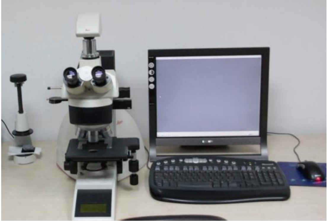
Resim 5.5. Leica DFC 320 dijital kamera bağlantılı Leica DM 4000 M marka optik mikroskop
