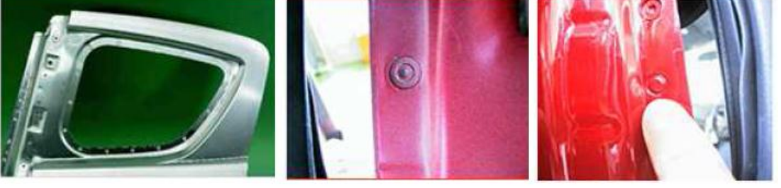
Resim 1.1. Sürtünme karıştırma nokta kaynağı kullanılarak üretilmiş Mazda RX-8'in yan kapı paneli ve noktaların görünüşü [1]
