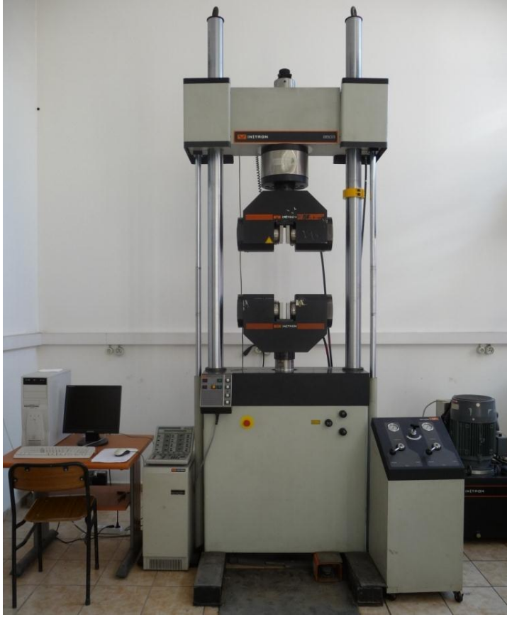
Resim 5.3. Instron 8503 model 500 kN çekme ve basma kapasitesine sahip universal test cihazı
