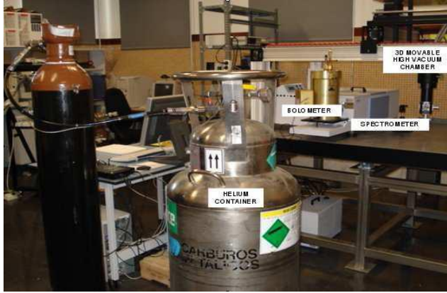
Şekil 5.27. Bir Helyum tankı ve bolometre örneği
