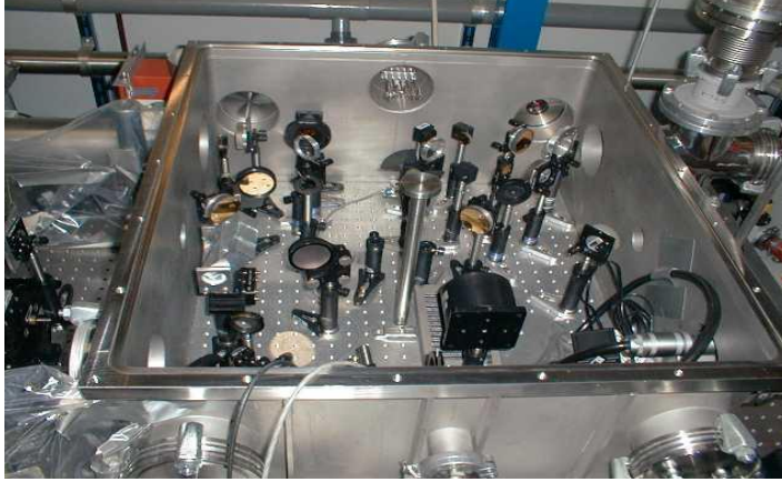
Şekil 6.14. FELIX pompa sonda deney düzeneği
