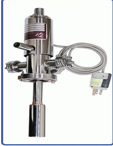
Şekil 5.21. Helyum akış tankı örneği
