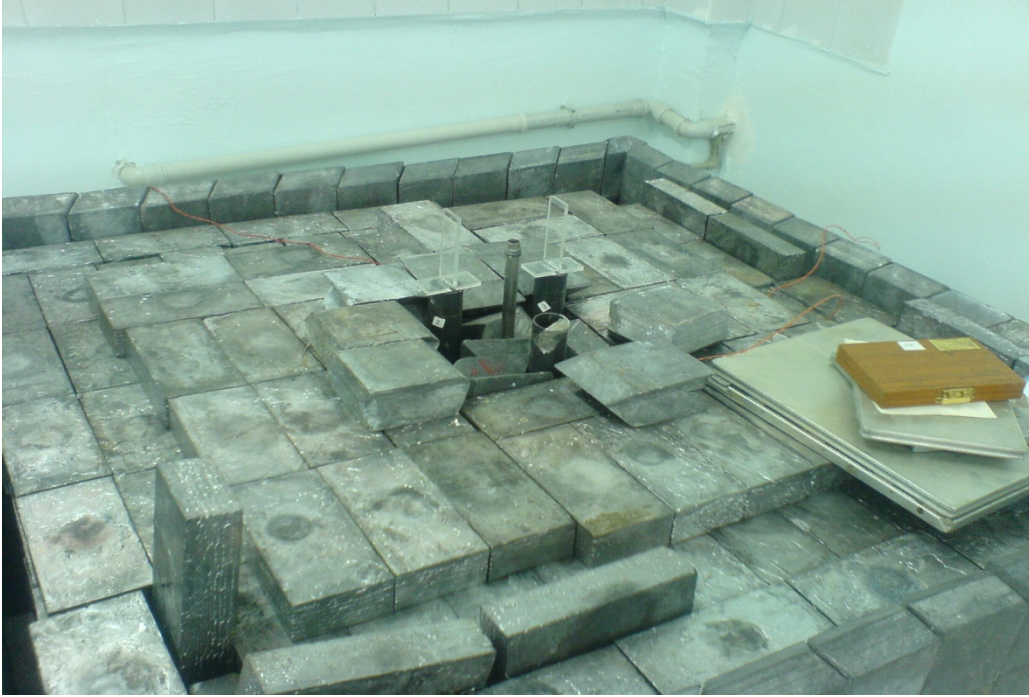
Resim 9.9. ^{241}\text{Am} -Be İzotopik Nötron Kaynağı
