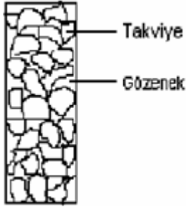
Şekil 5.7. Takviye tozlarının cam kap içerisinde oluşturdukları dolu hacim ve gözenekler [64].
