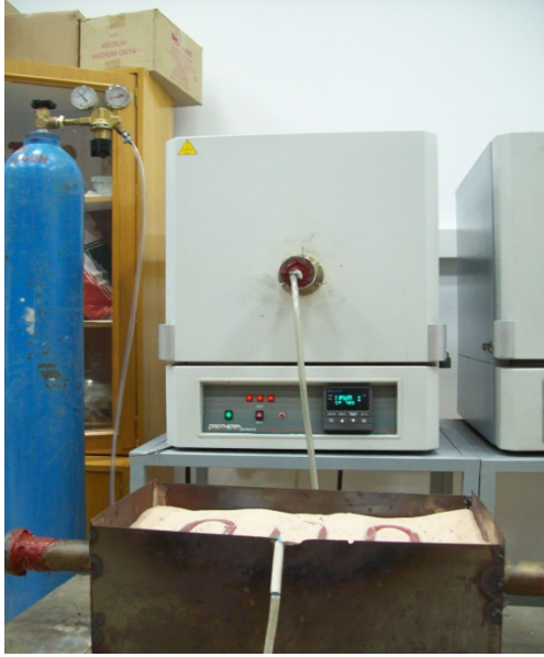
Resim 7.5. Sinterleme ısıl işlemi uygulanan fırın
