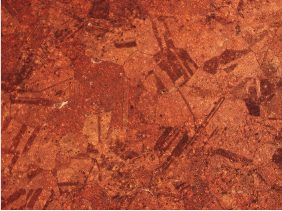
980 0 C de su verilmiş CuCr1Zr Alaşımı 10x büyütme
