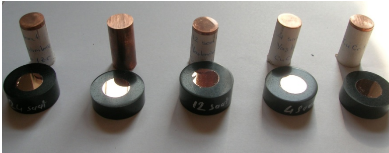
Resim 4.5 Kesilmiş ve bakalite gömülmüş elektrot numuneleri
