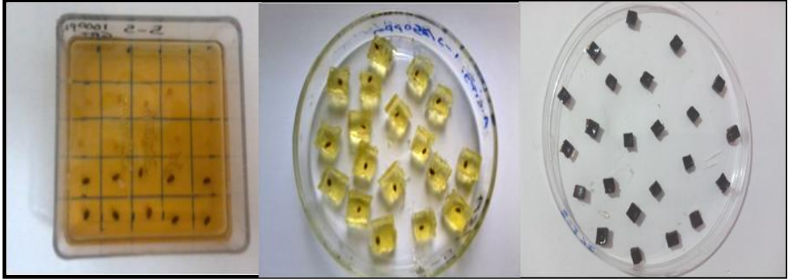
Resim 3.1. GA 3 yüklü iki farklı tohumlu hidrojellerin a) Kap içerisindeki b) Kesilmiş ve c) Kuru halleri
