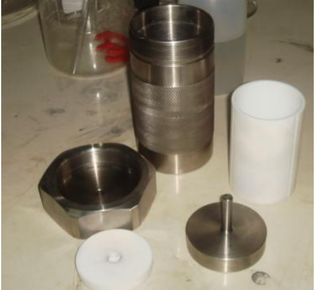
Resim 3.2. Hidrotermal Sentez için Kullanılan Teflon Kap ve Çelik Otoklav
