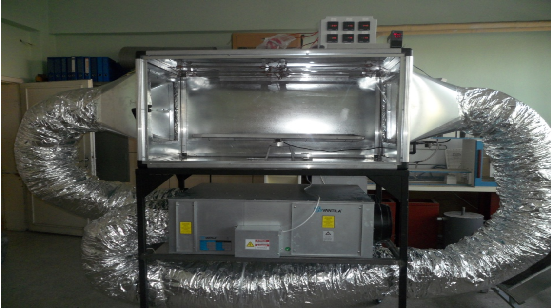
Resim 3.10. Kızılötesi ışınımlı (infrared) ısıtıcı kullanan kurutma sistemi ön görünüşü
