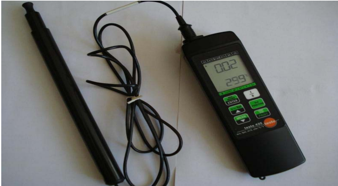
Resim 3.8. Hava hızı ve sıcaklık ölçüm cihazı
