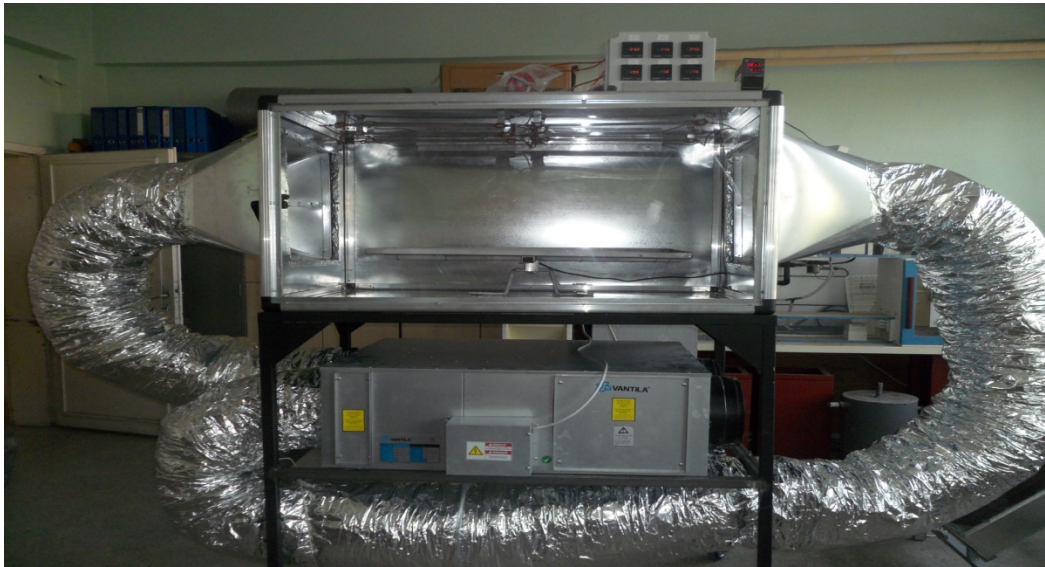
Resim 3.1. Kızılötesi ışınımlı (infrared) ısıtıcı kullanan kurutma fırını
