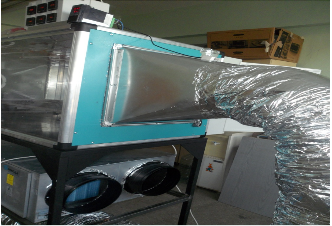
Resim 3.12. Isı geri kazanım cihazı yan görünüşü
