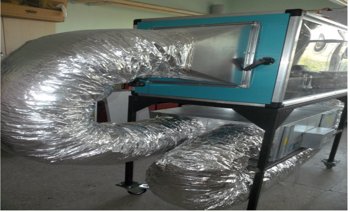
Resim 3.11. Kızılötesi ışınımlı ısıtıcı kullanan kurutma sistemi sol yan görünüşü
