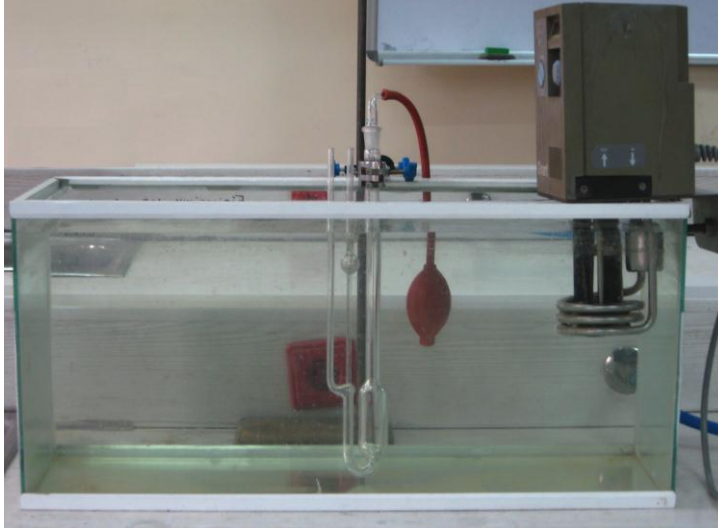
Resim 3.2. Viskozimetrik ölçümlerin yapıldığı deney düzeneği
