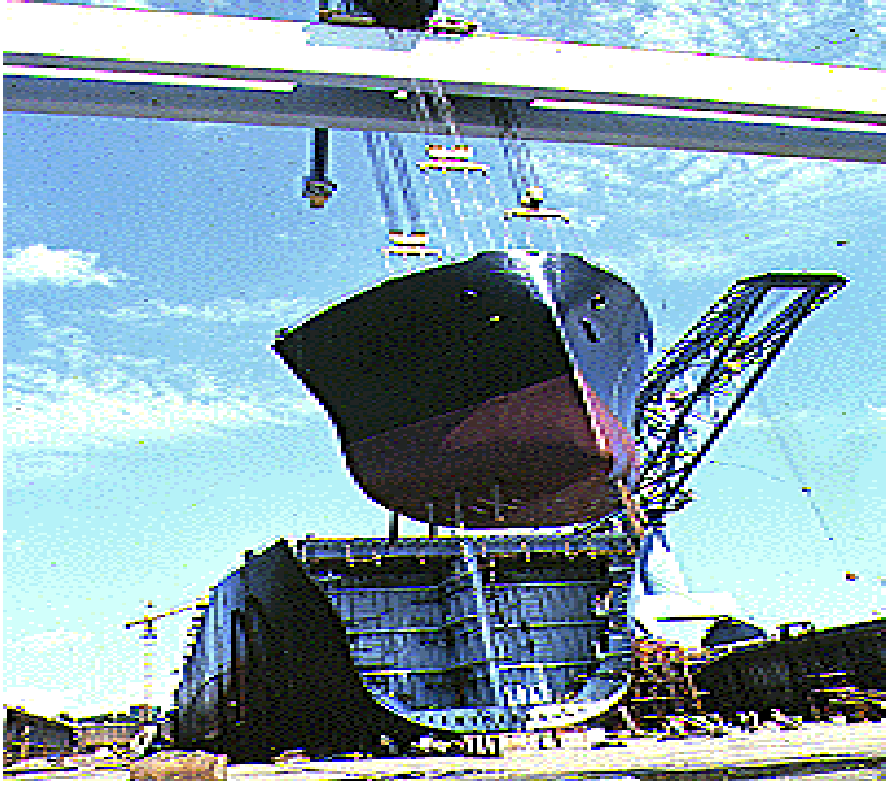
Resim 4.4. Gemi pruvasının gemiye eklenmesi [27]
