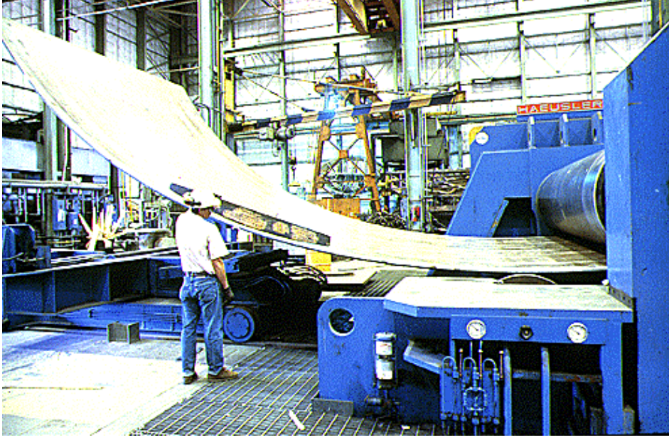
Resim 4.2. Çelik sacların bükülmesi [27]
