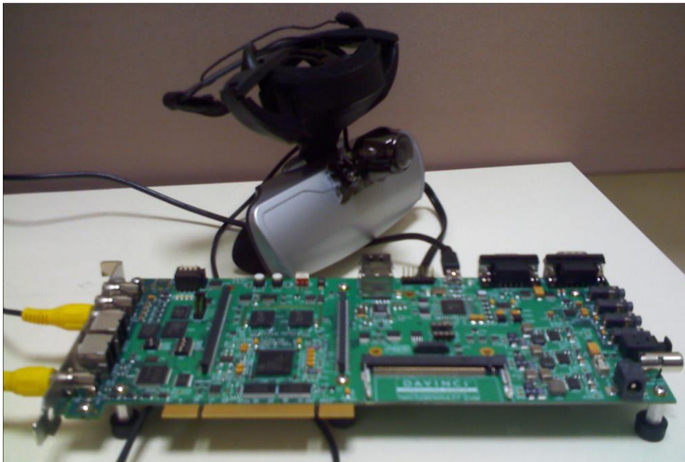
Resim 4.2. Geliştirilen DaVinci tabanlı görsel protez simülasyon sistemi
