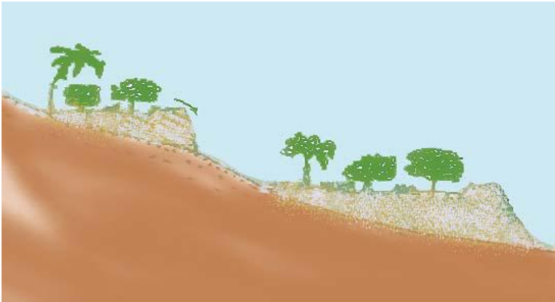
Şekil 3.3. Vadide eğim boyunca inşa edilen Jessour (teras)
