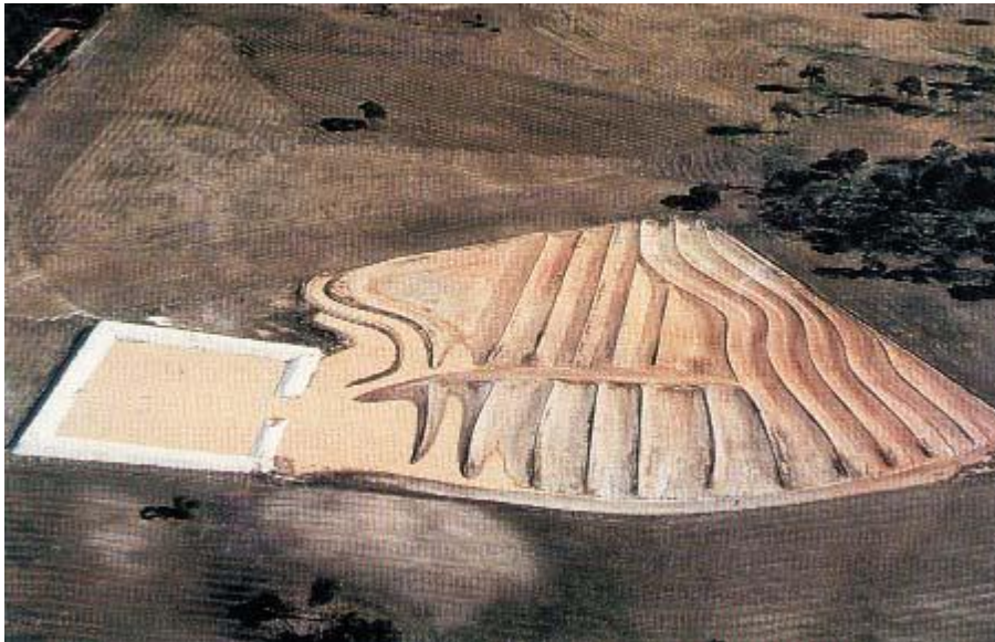
Resim 3.22. Avustralya'daki bir gölette yüzey akışı toplayan sıra arası sistemi
