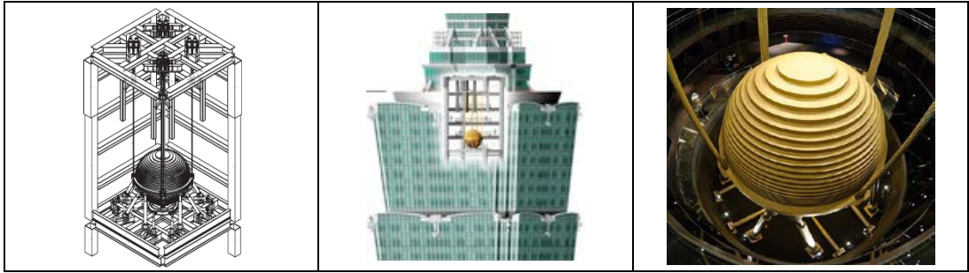
Şekil 2.8. Taipei Finans Merkezi’nde şematik kütle sönümlenme sistemi [61]
