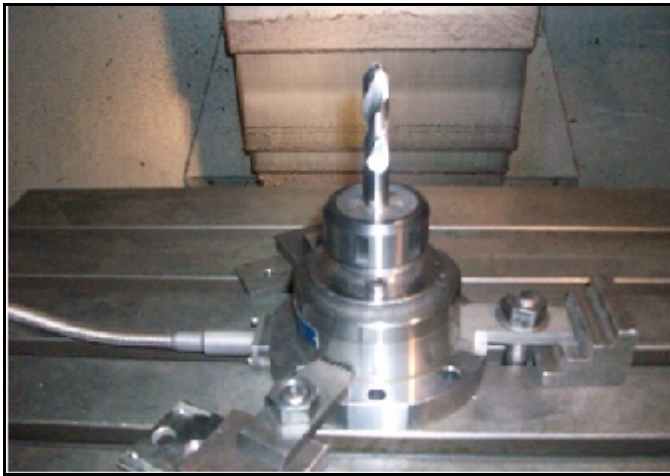
Resim 5.4. Matkabin tutucudan mesafesinin ayarlanması.
