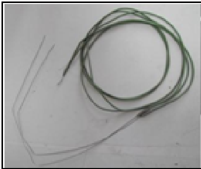
Resim 5.1. Sıcaklık ölçüm için kullanılan K tipi ısıl çift (thermocouple)
