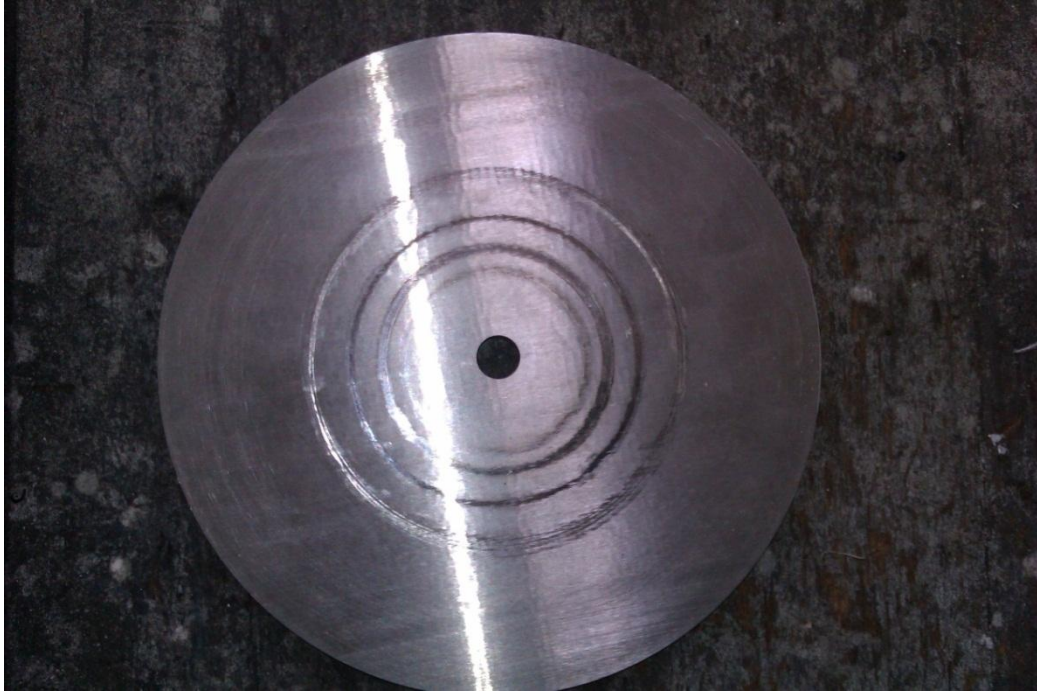
Resim 6.1. Aşınma deneylerinde kullanılmış bir disk
