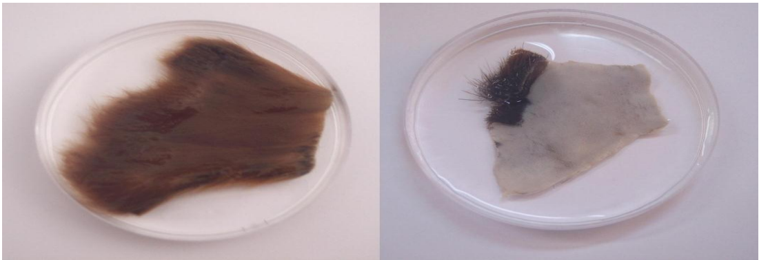
Resim 2.6. Proteazın 24 saat 37 °C' de keçi kılıyla muamelesi ( sol: kontrol, sağ: test sonucu) [46].
