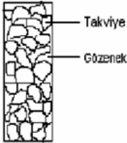
Şekil 2.10. Takviye tozlarının cam kap içerisinde oluşturdukları dolu hacim ve gözenekler [59]
