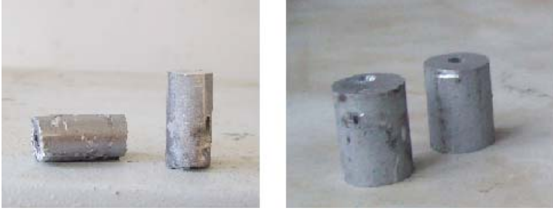
Resim 3.7. İnfiltasyon borularından çıkarılmış ve kesilmiş numuneler.
