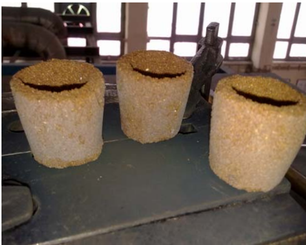
Resim 3.3. Sıvı metal akışını sağlayan yolluk sistemi.
