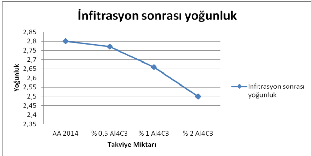
Şekil 4.1. Takviye hacim miktarına bağlı olarak yoğunluk değişim
