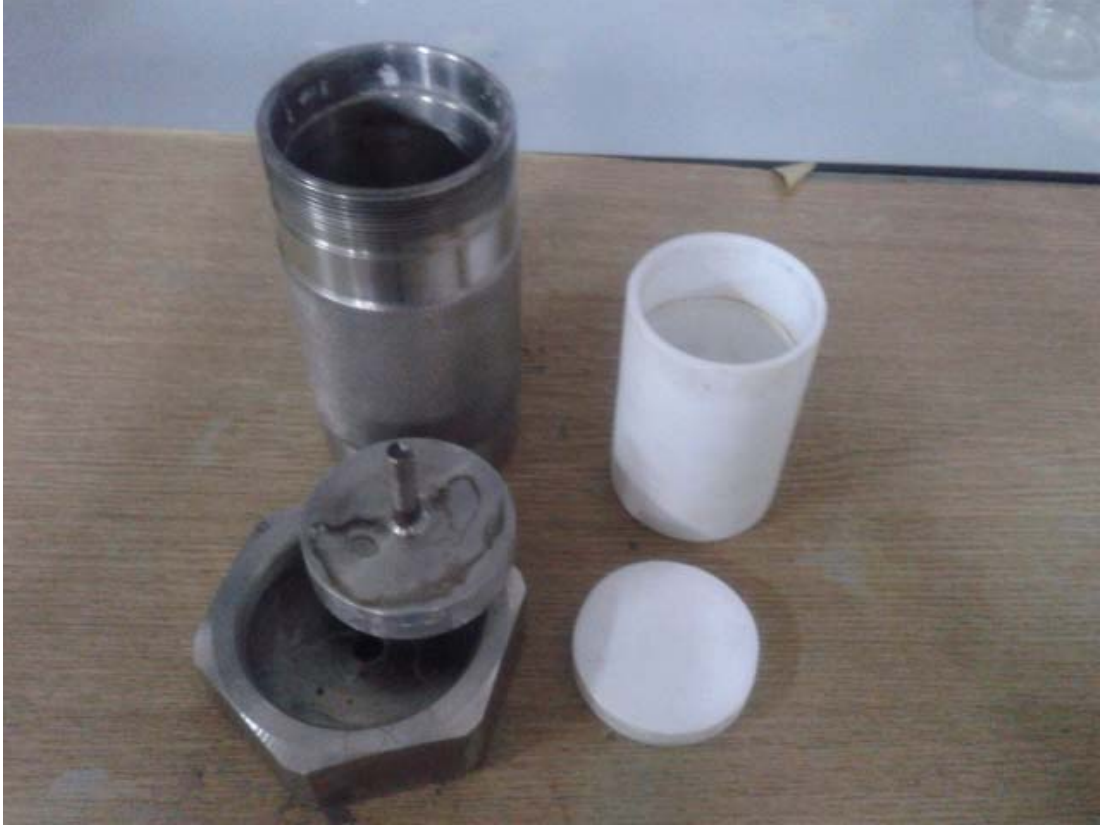
Resim 3.2. Hidrotermal Sentezin içerisinde gerçekleştirildiği Teflon Kap ve Çelik Otoklav
