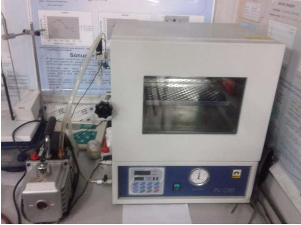
Resim 3.3. Vakumlu kurutma fırını
