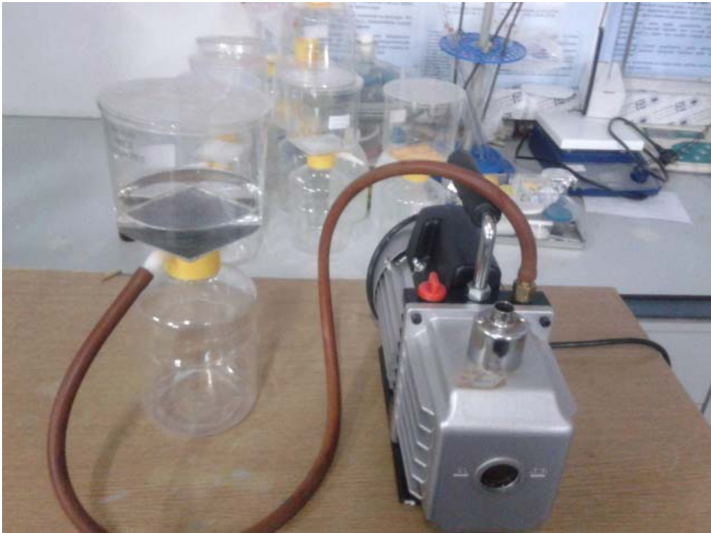
Resim 3.4. Filtreli Yıkama sistemi
