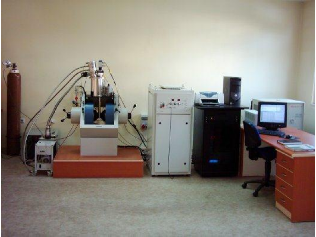
Resim 3.6. Lake Shore 7700 serisi Hall etkisi ölçüm sistemi.
