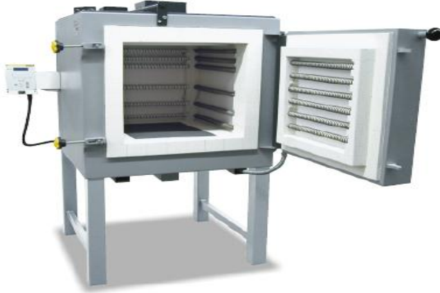
Resim6.2. Malzemelerin sinterlenmesinin yapıldığı fırın
