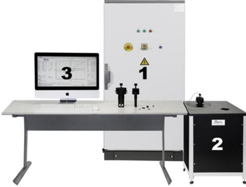
Resim 4.1. Hysterisis graph 8 kjoule capacitive decharger sisteminin genel görüntüsü
